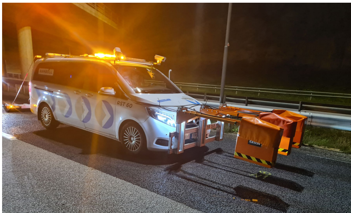
Figur 3: Sir 30 system fra GSSI med 3 stk 2 GHz antenner montert på Rambølls målebil. Foto: Kim Rune Grannes Statens vegvesen
