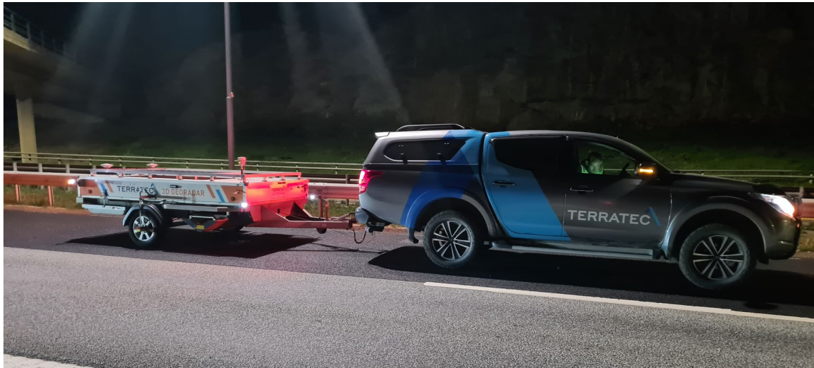
Figur 5: 3D radar fra Kontur, bygget inn i tilhengeren av Field. Foto: Kim Rune Grannes Statens vegvesen
