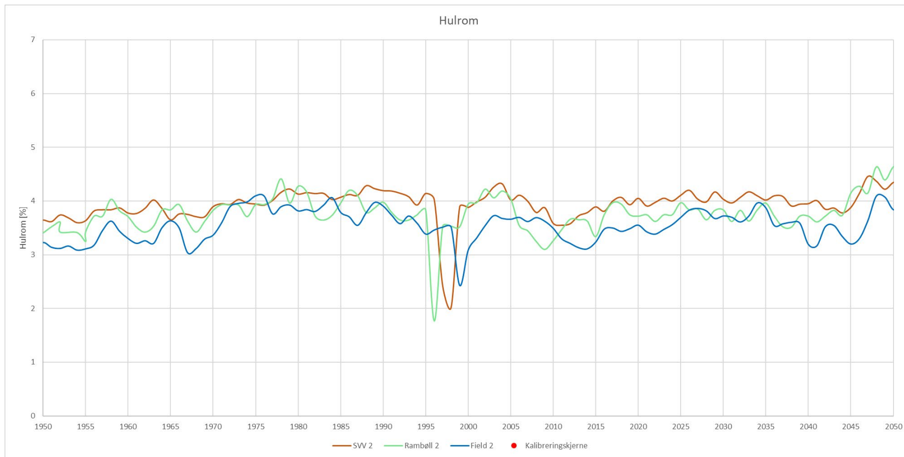
Figur 20 Sammenligning av hulrom fra alle måleutstyr på utvalgt strekning for måling 2
