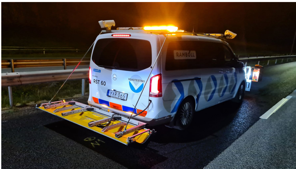
Figur 4: 3D radar fra Kontur montert på Rambølls målebil. Foto: Kim Rune Grannes Statens vegvesen
