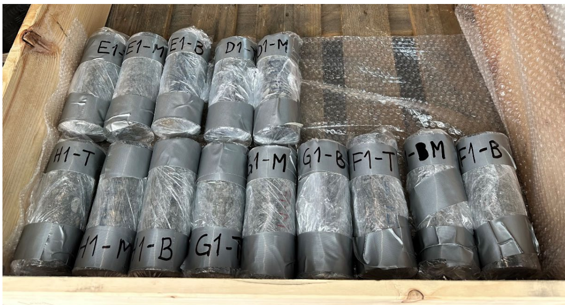
FIGUR 10 PLASTINNPÅKEDDE OG MERKEDE KJERNER FRA ELEMENT D1–H1. FOTO: EVA RODUM, STATENS VEGVESEN.
