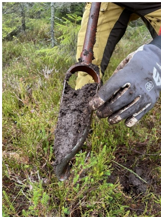
Figur 8: Prøvetaking med myrkannebor av torv fra myr. Foto: Amalie Krog Klette
