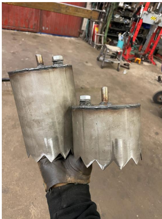
Figur 9: Tetthetsmålere utviklet for prosjektet på hhv. 1 og 2 liter. Foto: Pål Magnus Lunner
