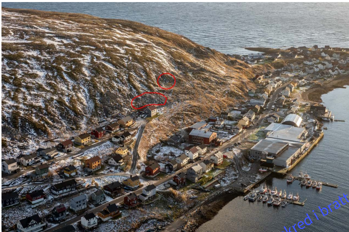
Figur 8 Ovenfor skolen og barnehagen er det to løснеområder markert med røde sirkler som kan nå ned til byggene ved årlig sannsynlighet 1/1000. Barnehagen er mest utsatt, men der er bakveggen av betong og tåler på grunn av byggingen av et slikt snøskred. Skolen ligger utenfor rekkevidde for skred med gjentakstintervall 1/1000.
