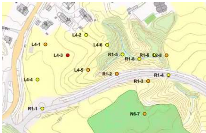
Figur 5-12: Tidligere utførte grunnundersøkelser nord for Fjellinna. Prefiks L- ref. [22] og R- ref. [27]. Rød – kvikkleire påvist, oransje – kvikkleire antatt, gul – antatt ikke kvikkleire, grønn – påvist ikke kvikkleire.
