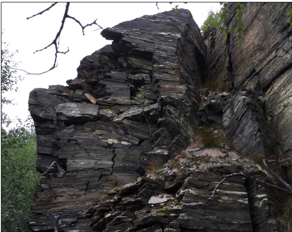
Figur 31: Avløst bergparti i skrenten over skoleplassen mot nord.
