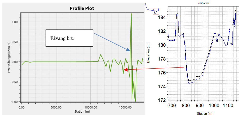
Fig 4.4a Bunnendring i m for strekningen Ringebru til innløp Losna. Øvre grensebetingelsen er tilløpsflom juni 2011. Nedre grensebetingelse er senket vannstand til 182 m i Losna.
