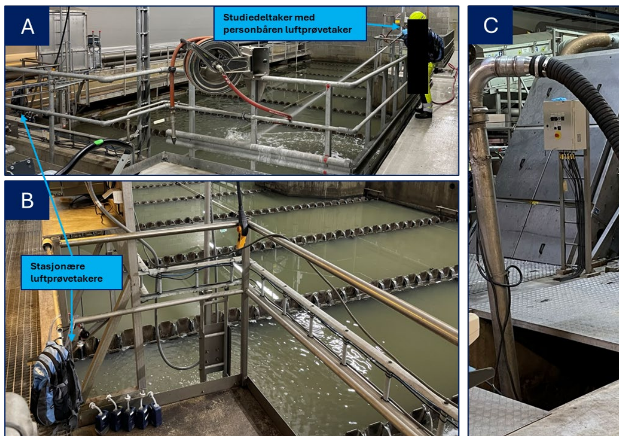
Figur 13: Prosesshallen (sedimenteringsbassenget) og gruskammeret i anlegg B. (A) Stasjonær prøvetaking under manuelt arbeid, med en studiedeltaker (personbåren prøvetaking) som utfører spyling av bassenget og rennene. Vannstrålen fra arbeideren spruter her i retning av prøvetakerne i venstre ende av bildet, noe som kan øke bioaerosoldannelse. (B) Stasjonær prøvetaking, sett fra prøvetakernes ståsted, uten at manuelt arbeid foregår. De stasjonære prøvetakerne er plassert på et gittergolv ca. 30-50 cm over vannoverflaten. (C) Ristene i anlegg B med åpent gruskammer under sandpumping. Denne prosessen er nå automatisert.
