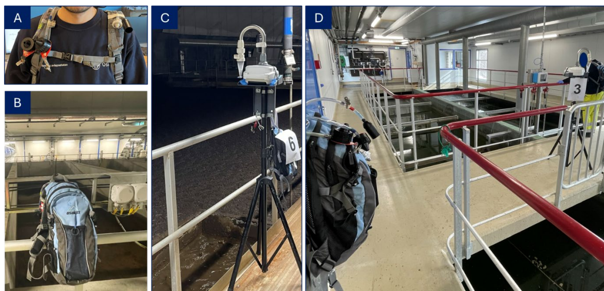
Figur 5: Eksempelvis utplassering av luftprøvetakere. (A) Studiedeltaker utstyrt med fire luftprøvetakere: 2xCIS, 1 PAS6 og 1 totalstøvkassett. (B) Utplassering av stasjonære prøvetakere (CIS, PAS6 og totalstøv) ved sedimenteringsbasseng i anlegg A. (C) Utplassering av stasjonære prøvetakere (Coriolis og sekk utstyrt med CIS, PAS6 og totalstøv) ved et biologisk rensebasseng i anlegg A. (D) Utplassering av stasjonære prøvetakere på sekk (CIS, PAS6 og totalstøv), Coriolis og studiedeltaker utstyrt med personbårne prøvetakere (CIS, PAS6 og totalstøv) ved flokkuleringsbasseng i anlegg C.
