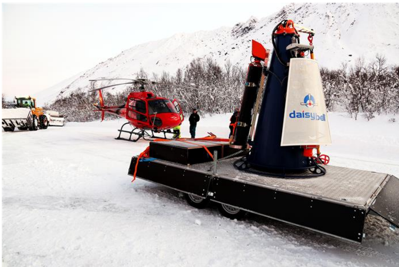
Figur 7.3.5—1 — Skredklokke, av typen DaisyBell, klar for bruk i Holmbuktura i Troms i 2017. Foto: Geir Bakkevoll, Statens vegvesen.
