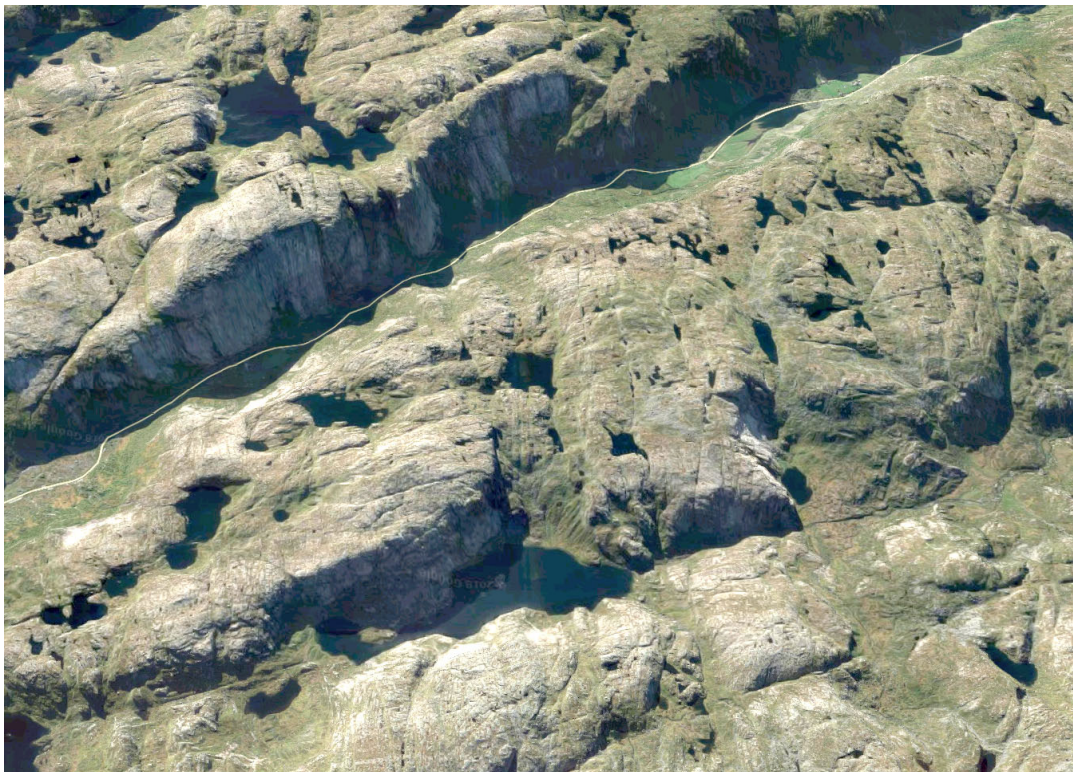
Fig. 5 Nettverk av svakhetssoner i et fjellområde i Sørvest-Norge. Potensielle svakhetssoner kan sees som linjer i landskapet som følge av glasial erosjon. Dybden av forsenkningene er i hovedsak et resultat av bergkvalitet, sonetykkelse og isbevegelsens retning. Veien som krysser bildet er 10 km fra kant til kant (Google Maps 2018)
