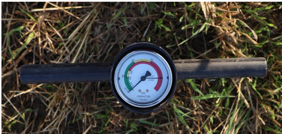
Bilde 5. Ved å presse penetrometeret nedover i jorda, vil pila i klokka på penetrometeret vise hvor stor motstand det er ulike steder nedover i jorda. Ved 300 psi, som er overgangen mellom gul og rød farge, er jordmotstanden så stor at det hemmer rotveksten. Når vi slutter å presse nedover vil den svarte pila gå tilbake til null, som på bildet.
