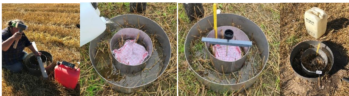
Bilde 6. Infiltrasjonsmålinger. Det brukes to ringe ved infiltrasjonsmålinger i forskningssammenheng. Det hellers vann i begge ringene, men infiltrasjonshastigheten leses bare av i den indre ringen. Der det er mye stein i jorda eller hellende terreng kan det være utfordrende å få ringene nok og jevnt ned. Til venstre ser vi Kari Bysveen fra NLR innlandet som har full innsats for å få ringene jevnt ned.
