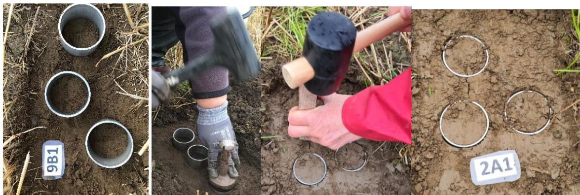
Bilde 4. Plassering av tre metallsylindre til uttak av jord til bestemmelse av porevolum og jordtetthet.
