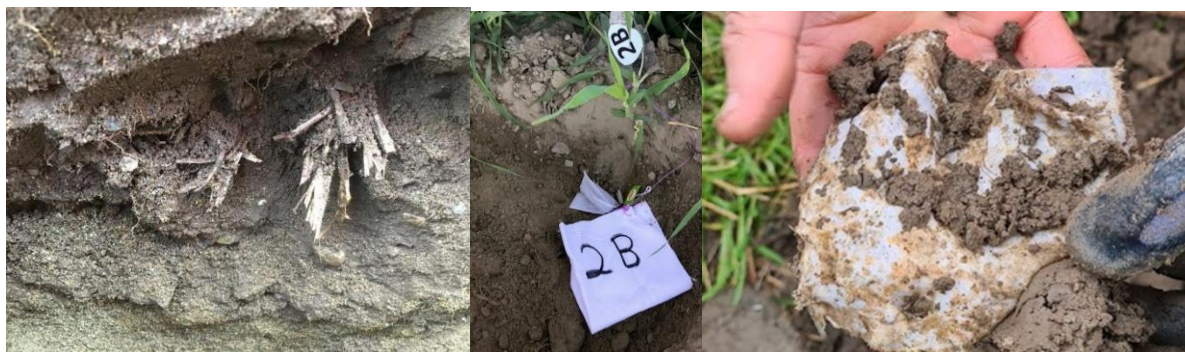
Bilde 10. Eksempler på uomdannede planterester, nedgraving og gjenfinning av bomullsklut og tepose.
