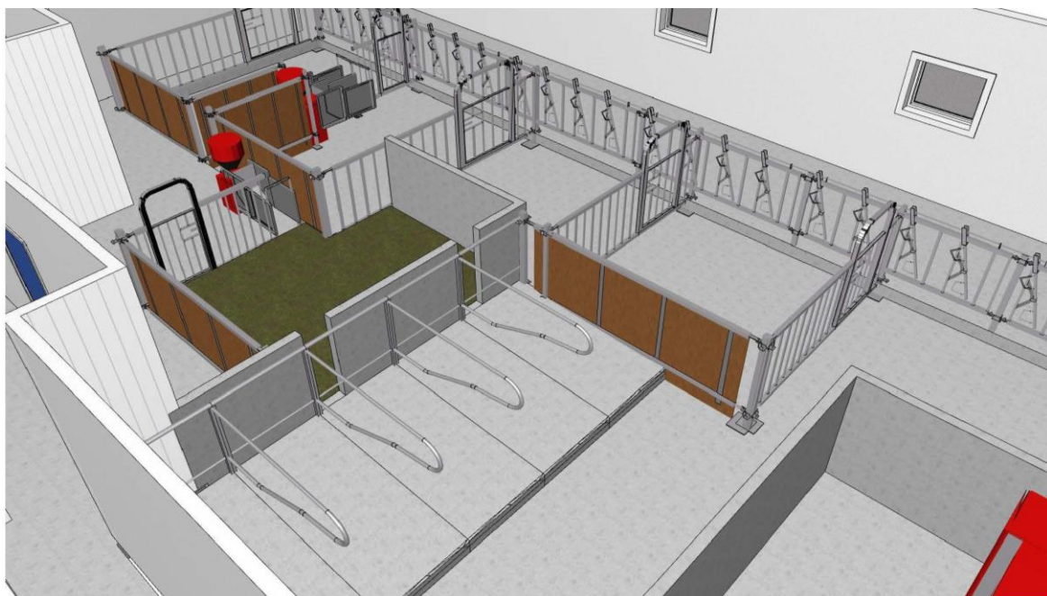
Figur 16. 3D tegning av løsning i eksempel 2 Fokusavdeling med utskåret passasje for spedkalver inn i kalvegjemmet.
