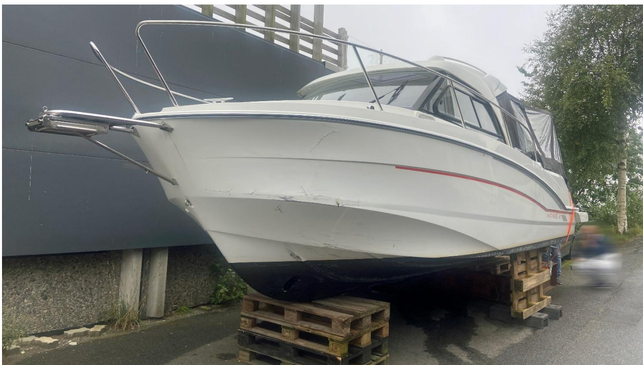
Fritidsbåten med skader på babord side av skroget. Foto: SHK
