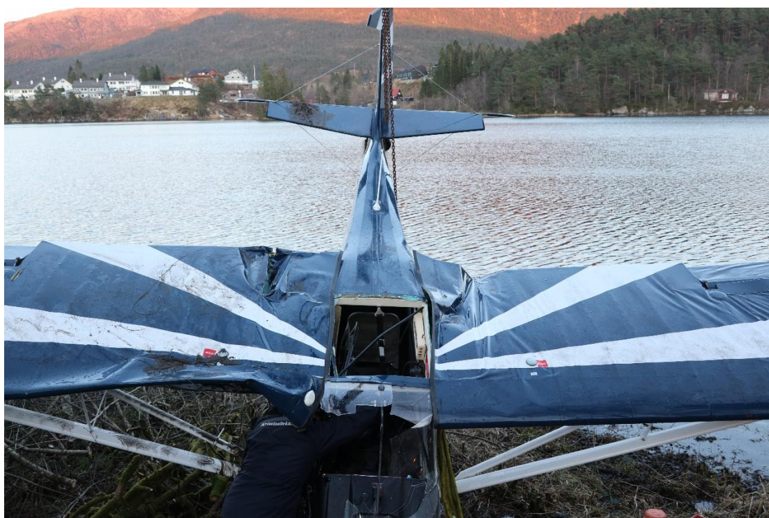
Flyet kort tid etter heving og transport til land. Bildet viser begge drivstofflokk montert. Foto: SHK
