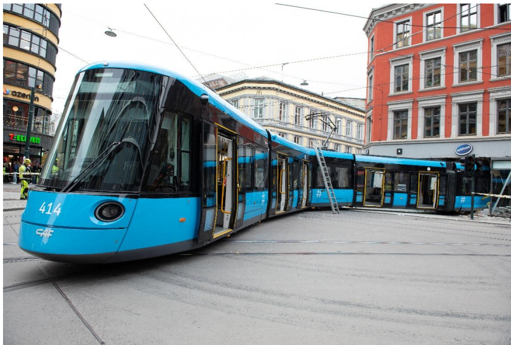
Vogn 414 avsporet i krysset mellom Nygata og Storgata. Foto: SHK
