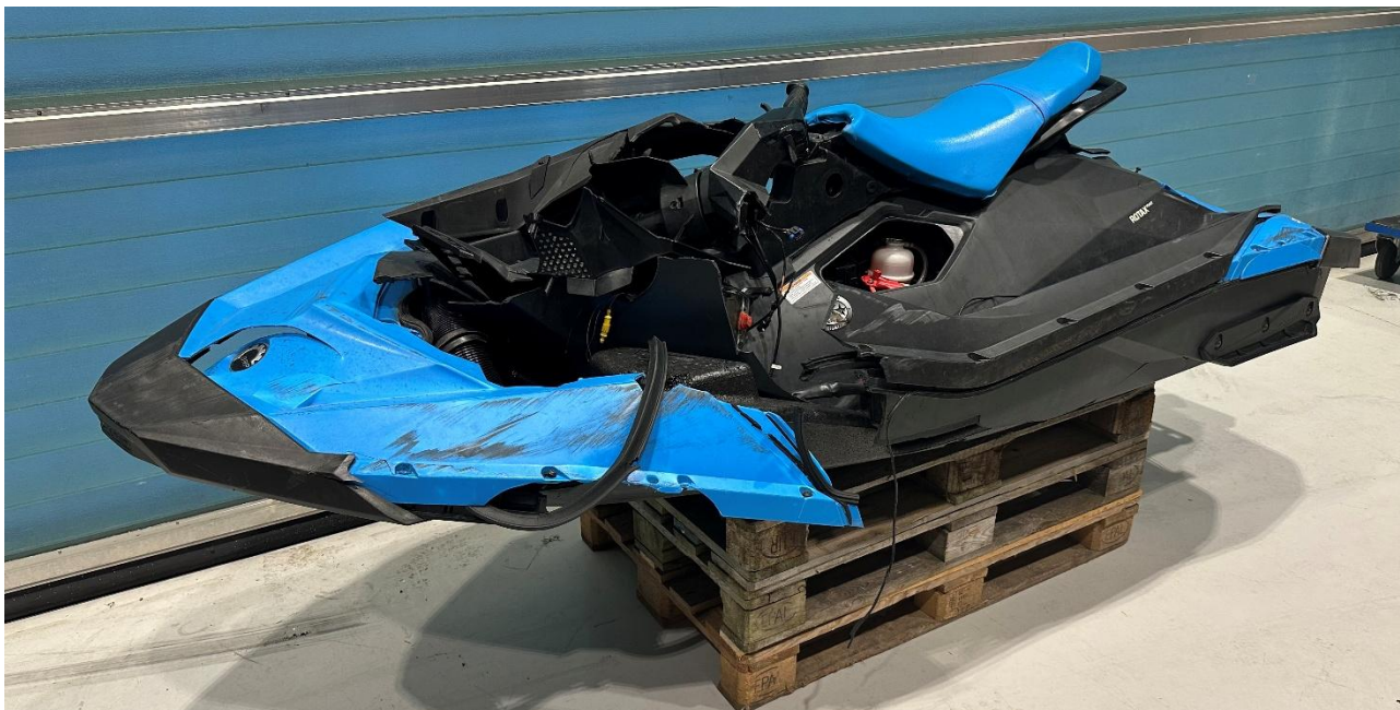
Skader på vannskuteren hvor babord side av styret var brukket av og skroget var delvis knust. Foto: SHK
