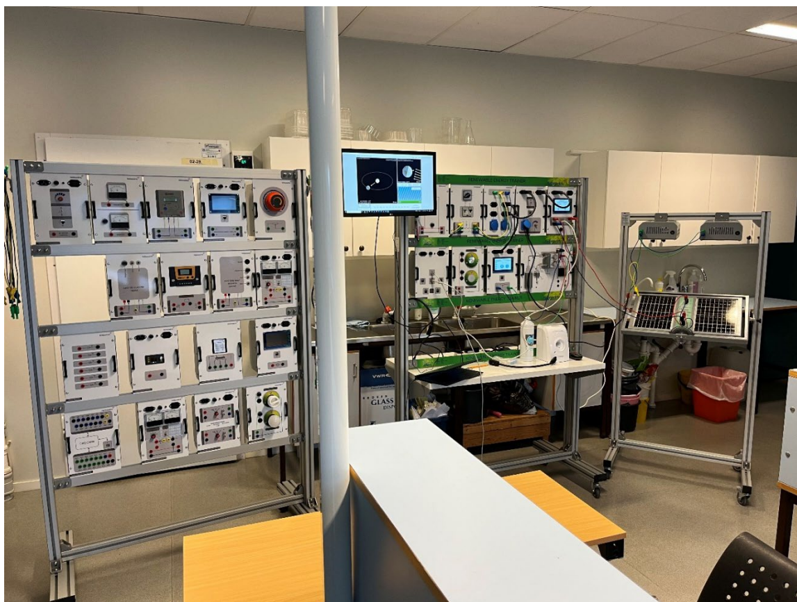
Figur 7: Hybrid fornybar energistasjon for eksperimenter knyttet til solceller, vindkraft og hydrogen.
