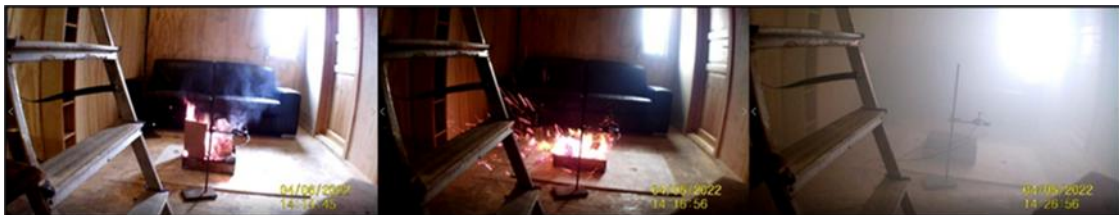
bilde 9 Fra forsøk med gass-slokkeanlegg i leiligheten i 'Hall of flame'
