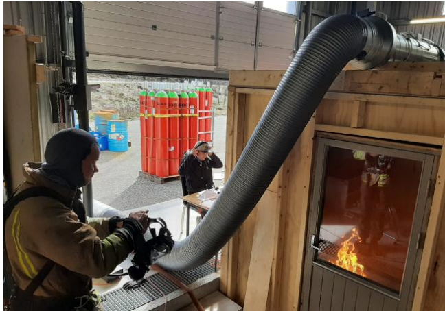
bilde 8 Fra tester i fullskala 'dummy' bolig i Hall of flame HVL
