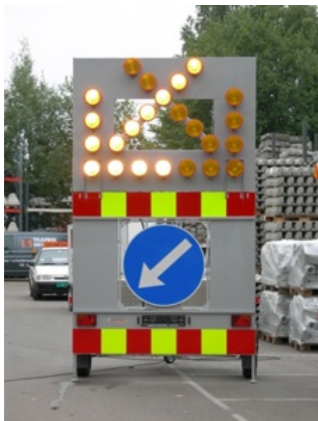
Figur 12.2.2—1 — Eksempel på blinkende lyspil på varselpanel
