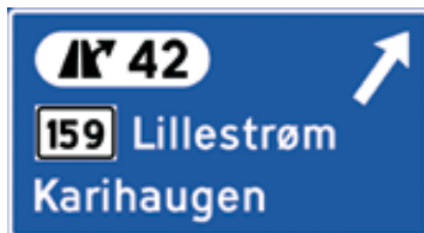
Figur 8.4.7—3 — Eksempel på portalvegviser 719.2 og 719.4
