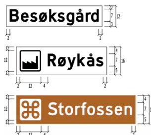
Figur 8.2.4—2 — Plassering av symboler og tekst på felt med annen bunnfarge
