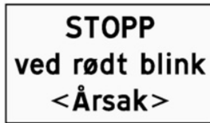
Figur 9.4.5.3—1 — Utforming av underskilt 808 på trafikksignal
