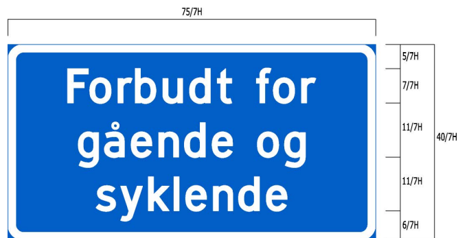
Figur 6.4.41—2 — Utforming av skilt 560.2
