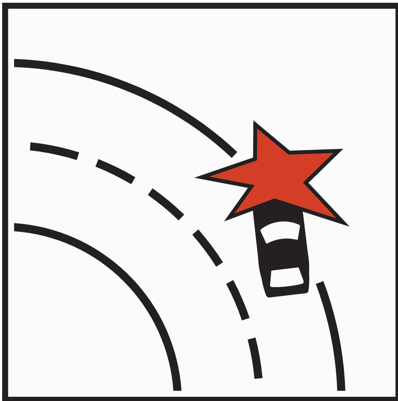
Figur 9.4.11—1 — 817.1 Særlig ulykkesfare. Eksempel på utforming
