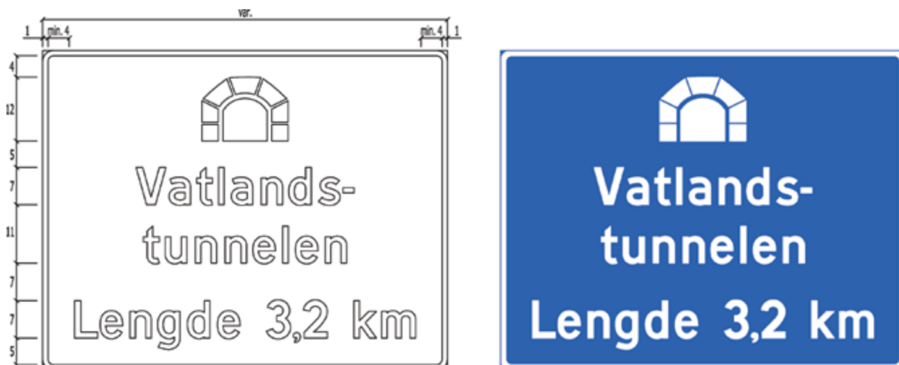
Figur 8.5.3—6 — Utforming av skilt 727.4
