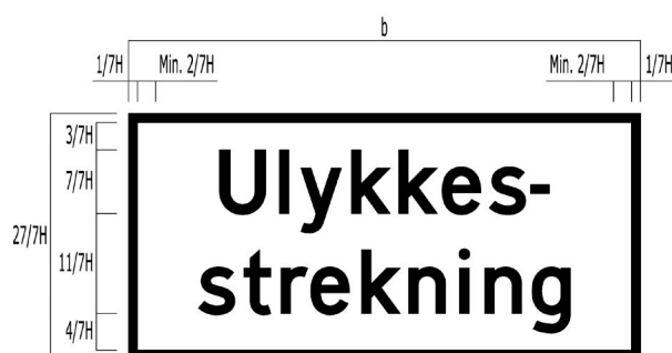
Figur 9.4.5.4—2 — Plassering av tekst på underskilt 808 - 2 linjer
