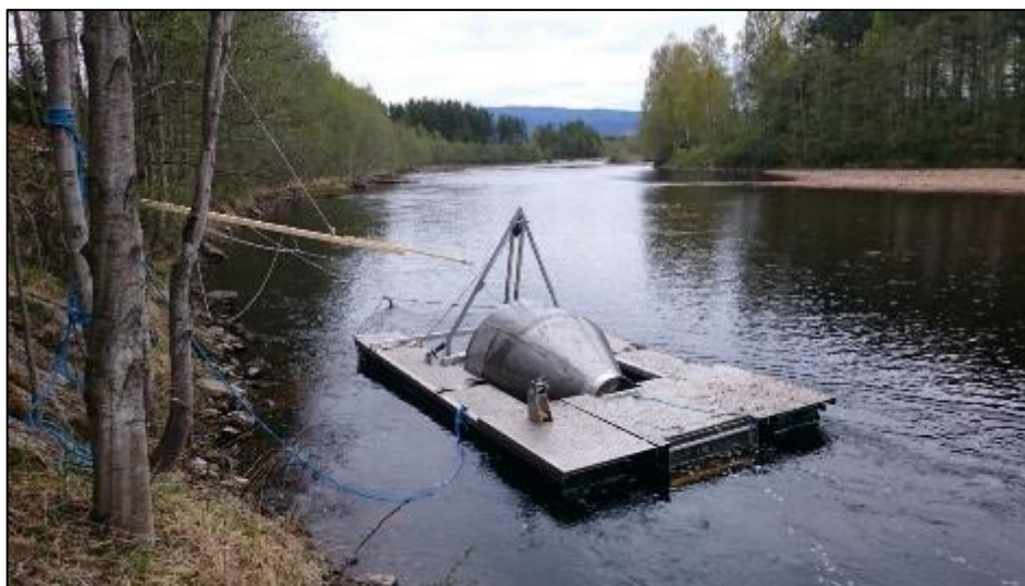
Figur 2.4. Plasseringen av skrufella i Heddøla ved Hustveit (Fellesfjøset) i 2017, på en dag med normal vannføring.
