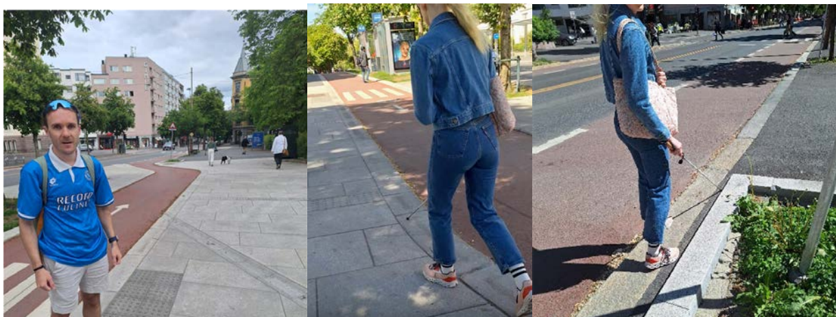
Figur 6.6: Vannrenne og fortauskant ble fulgt som veiviser, varselfeltet ble ikke oppdaget.
