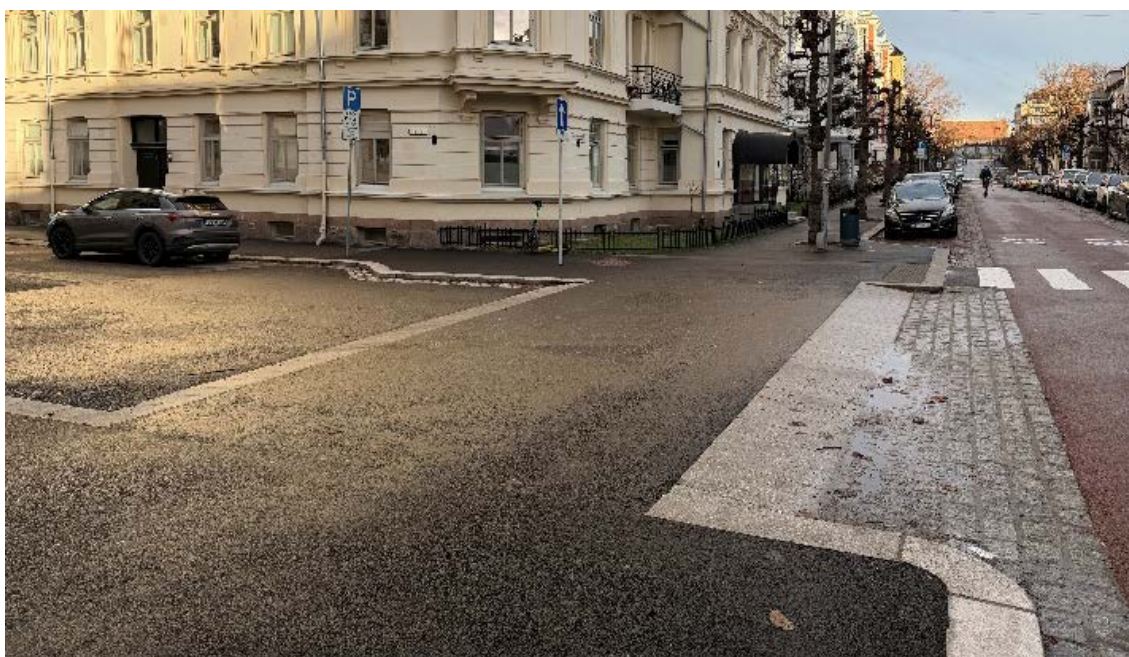
Figur 2.2: Gjennomgående fortau ved Tors gate kjennetegnes av et bredt fortau uten noe oppmerking eller ledelinjer ved krysset, asfalt er brukt som materiale.
