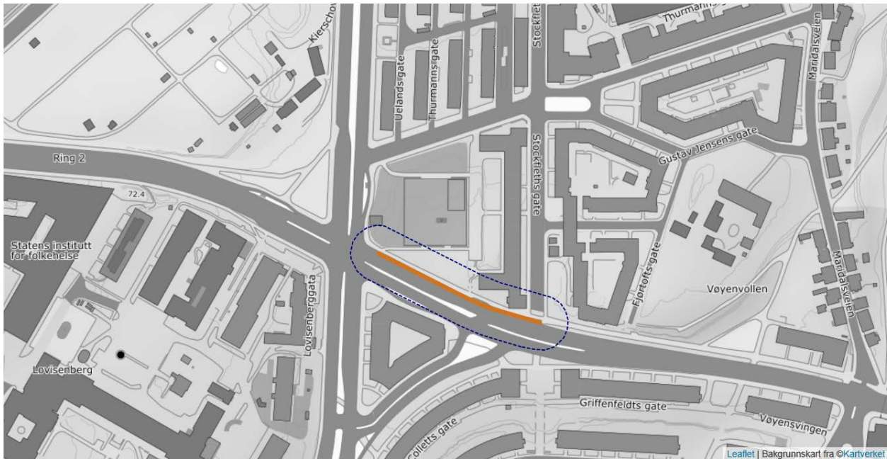
Figur 3.4: Opphøyd sykkelfelt på Ring 2 i Oslo, med 20 m buffersone.
