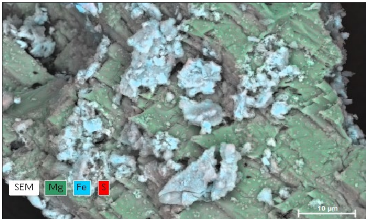
Figur 36. Prøve P2, område P2-map1-area. Elementkart viser Fe-okshydroksidet ferrihydritt og goethitt med litt S (lys blå til rosa) og har ellers litt Al, Si og Ca. Mineralet er utfelt på dolomitt (grønn).
