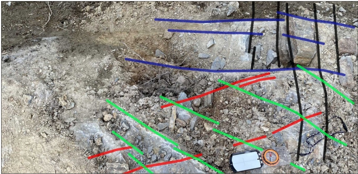
Figur 6. Foto tatt i ca. profil 9030 i BS2, mot nord. Svart er S1, blå er S2, rød er S3 og grønn er S4. Sammenlign med kart i figur 5 over. Ill: Statens vegvesen.
