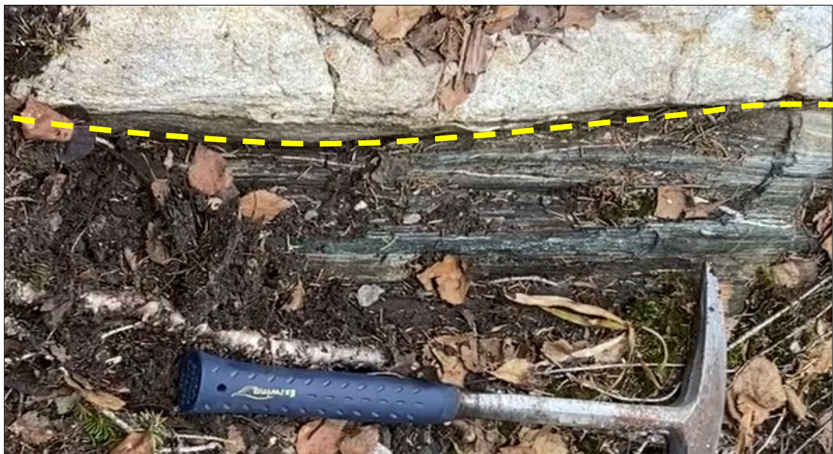
Figur 4: Foto av grensa mellom lys granittisk gneis og mørk skifrig kalkstein, illustrert med bergarts-grense i stipla gult. III: Statens vegvesen.
