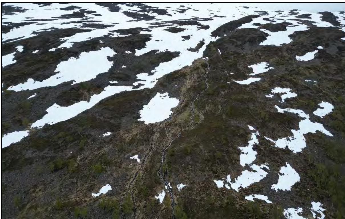
Figur 21: Dronebilde tatt mot NØ av elveløp sørvest i påvirkningsområdet. Basert på kartlagte og observerte avsetninger i nedre deler av dette elveløpet vurderer vi at det er aktuelt med løsneområder for sørpeskred i øvre deler. Sorpe2-1 gitt i registreringskartet er inntegnet i dette området.
