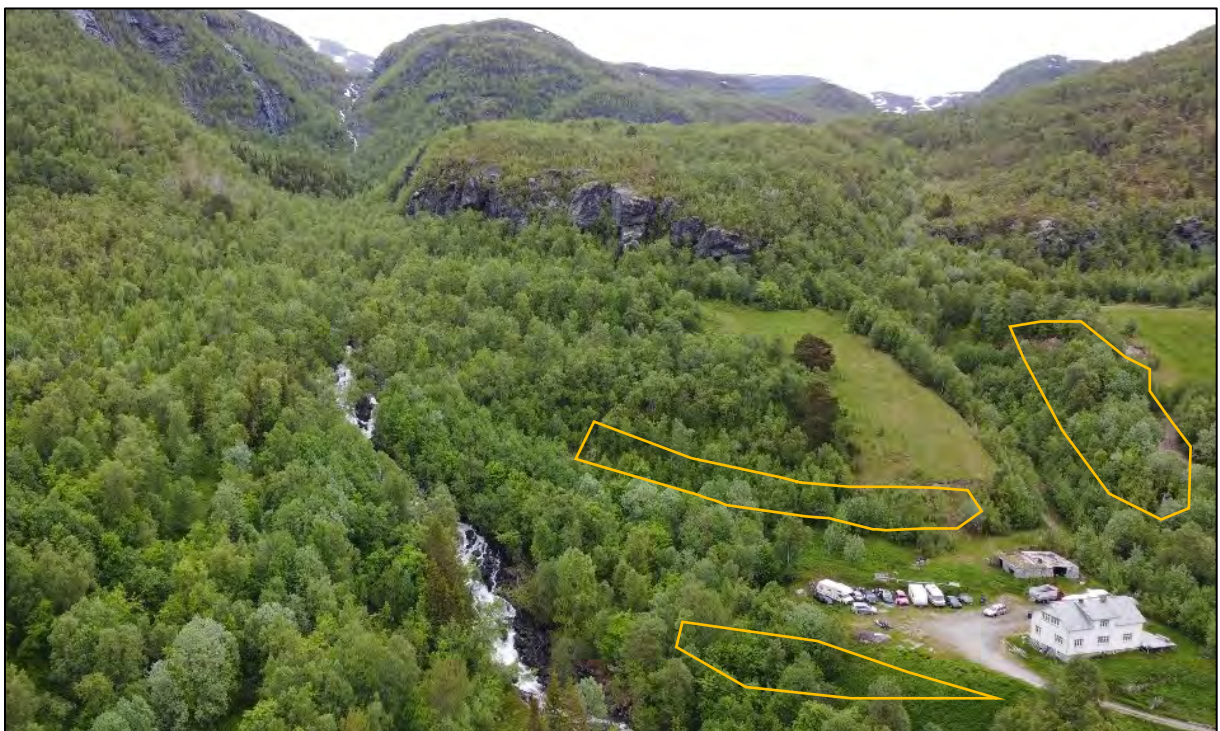
Figur 15: Bildet viser løsneområder for jordutglidninger, markert med oransje polygon.
