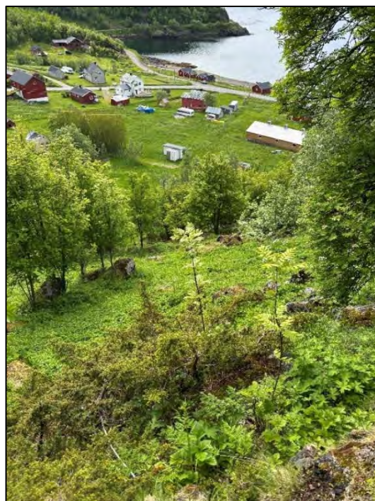
Figur 6: Bildet er tatt i vestlig del av påvirkningsområdet og ser mot vest ca. 55 moh. Skrent i venstre bildet representerer løsneområde for steinsprang og under ses flere steinsprangavsetninger. Langs med denne fjellsiden er det flere skrenter som representerer løsneområder for steinsprang. Bildet til høyre, ser man ned mot bebyggelsen og vestlig del av kartleggingsområdet.
