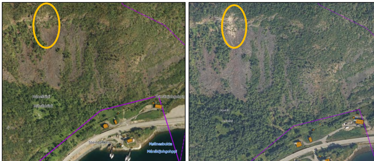
Figur 70: Flybilder fra 2018 t.v. og 2024 t.h. Sammenligning av bildene viser et lysere parti i det nyeste bildet som vitner om nylig steinsprangaktivitet.
