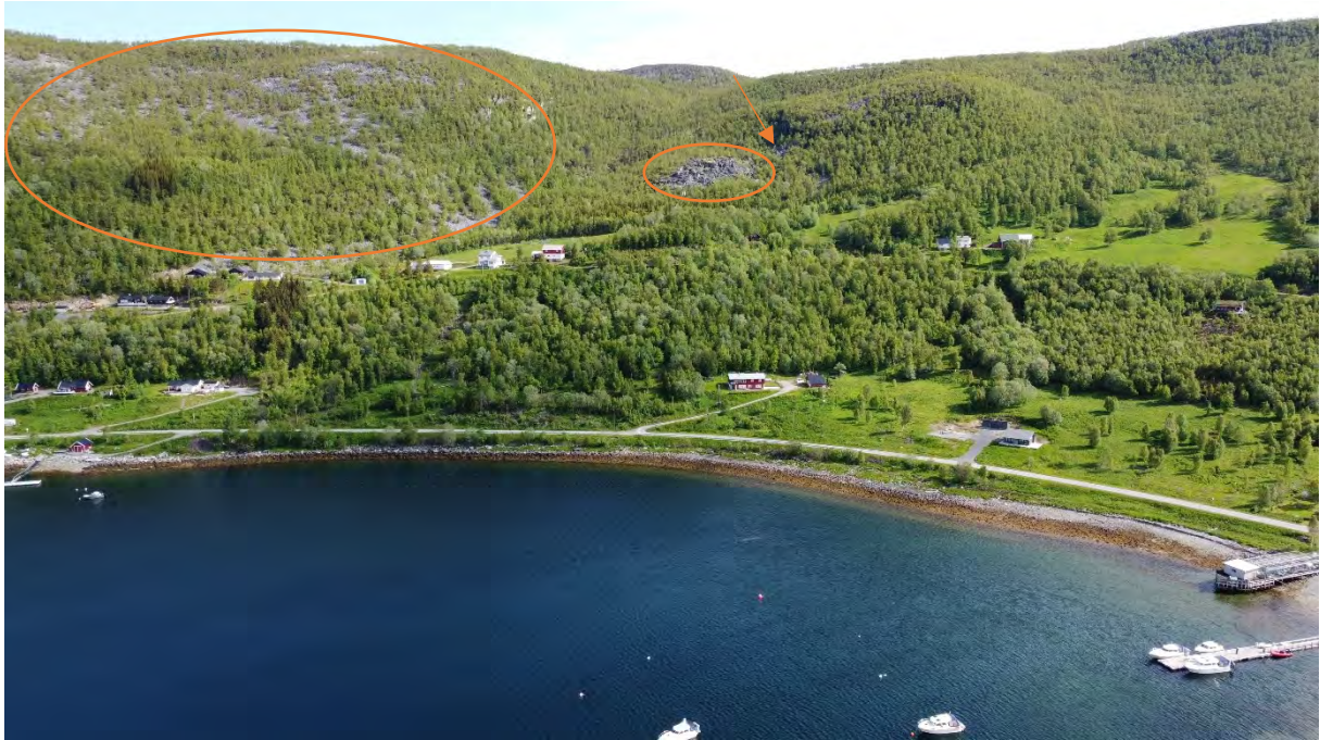
Figur 3: Forvittringsur med oransje omriss, og steinsprangur med oransje pil
