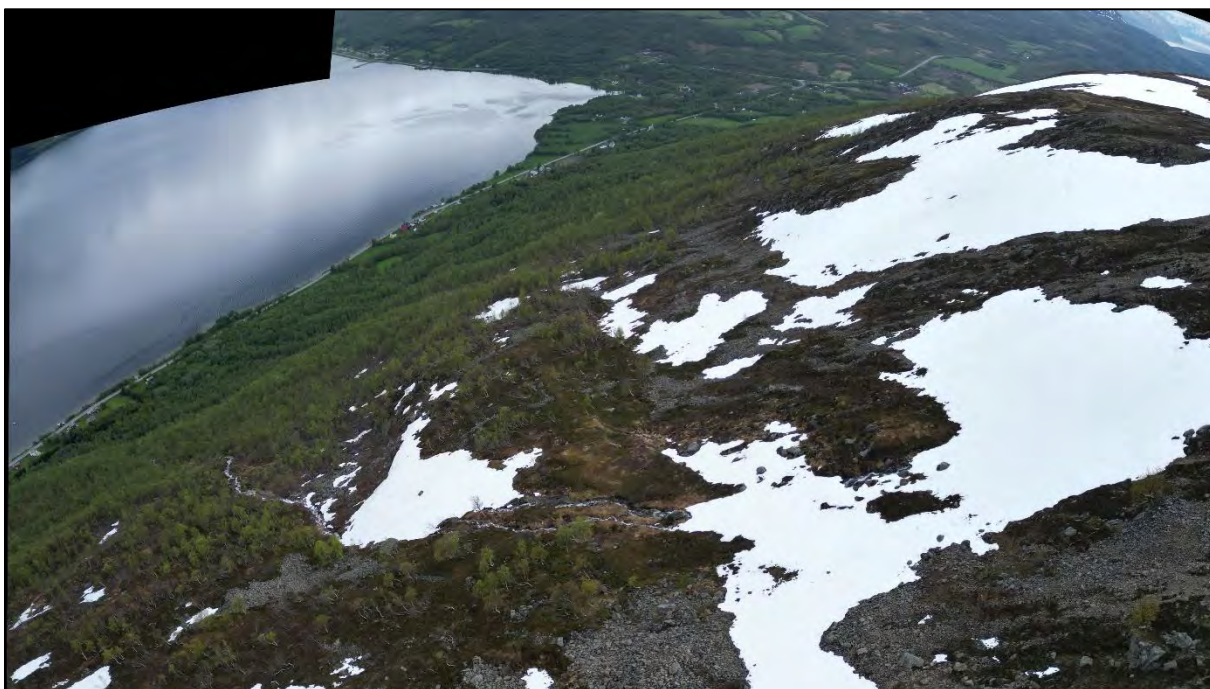
Figur 10: Nede til venstre i bildet ses elveløp NØ for Storelva. Løsneområde snøskred merket Sno-2-2 i registreringskartet ses til høyre i bildet. Midt i bildet ses også antydning til skredskadet skog. Bildet er satt sammen fra flere bilder og proporsjonene i bildet er stedvis noe forvrengt.
