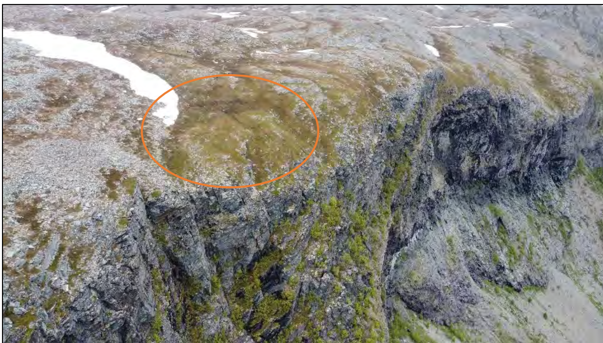
Figur 7: Mulig innsunket parti, markert med oransje.
