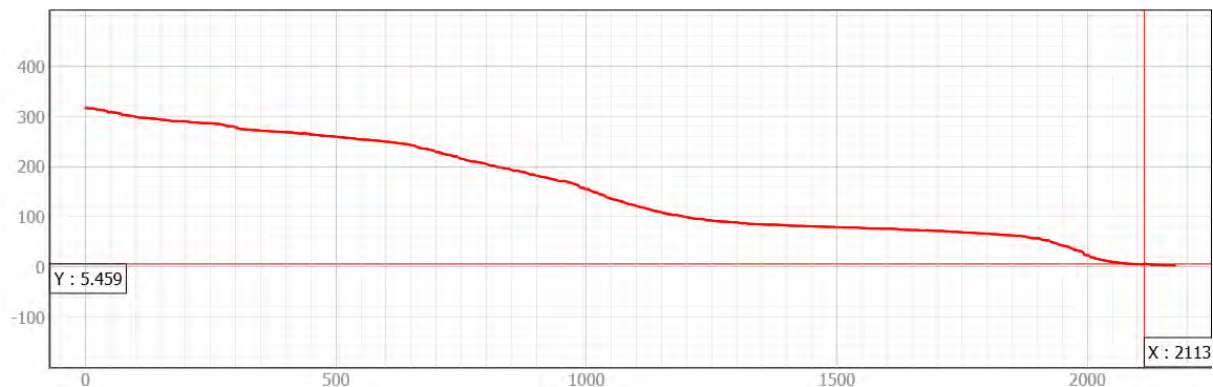
Figur 97: Figuren viser et lengdeprofil av Krokkelva. Aksene har samme oppløsning og viser antall meter. Profilet viser at det er et tilnærmet flatt område mellom 1200 m – 1900 m.
