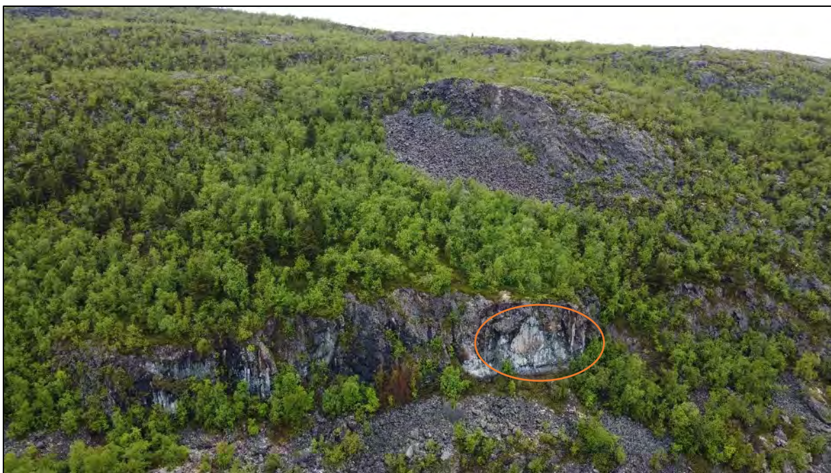
Figur 5: Bildet viser løsneområder for steinsprang og mulig steinskred i nordlige del av området.
