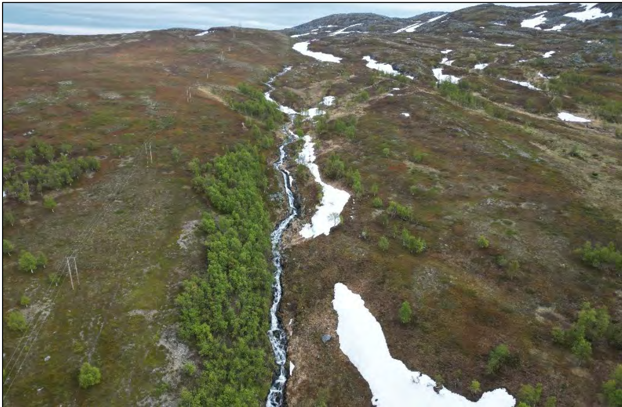
Figur 10: Øvre deler av Storelva sett med drone. Bildet ser mot sørøst. Særlig i overgangen mellom slakt til brattere terreng er det identifisert mulig løснеområde for sørpeskred.
