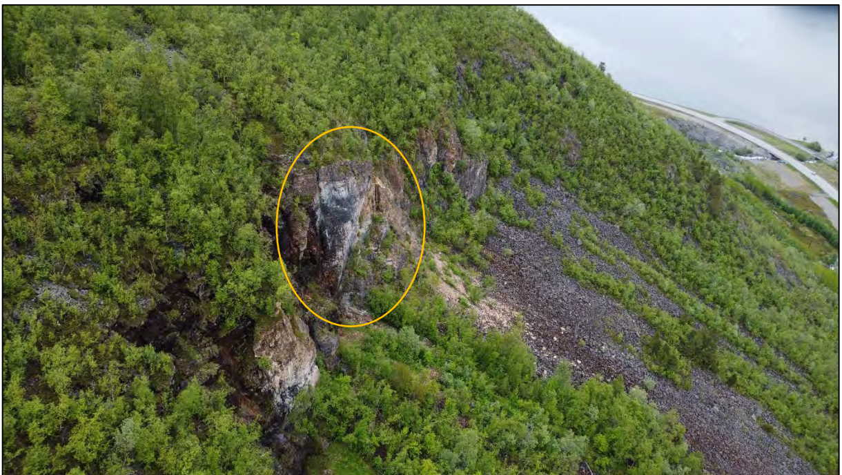
Figur 6: Bildet viser relativt fersk steinsprangaktivitet (datert til 2018-2024 fra flybilder), samt et relativt stort avløst bergparti med en vertikal baksprekk markert med oransje.
