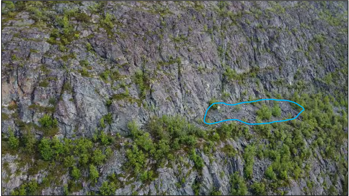
Figur 21: Eksempel på hylleformasjon i fjellsiden som teoretisk sett har gunstig terrenghelning for utløsning av snøskred, men ur og spredte trær reduserer løsnings sannsynligheten.
