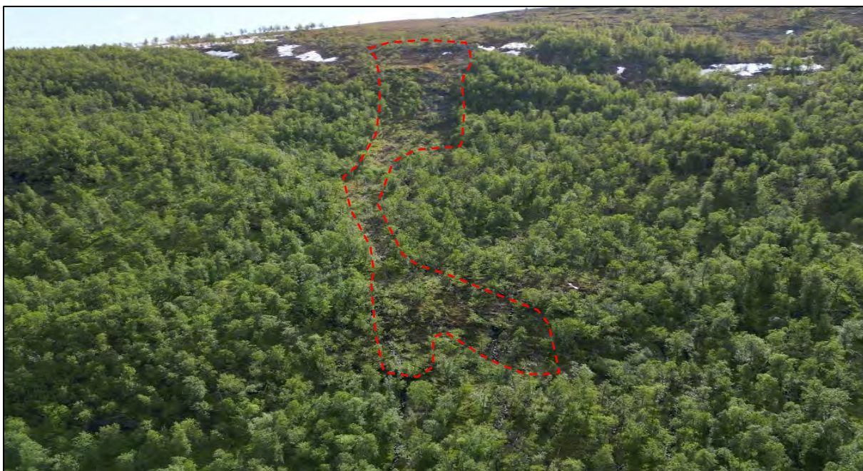
Figur 21: Bak Langfjordvegen 230 er det fravær av skog. Dette tolkes til å være på grunn av snøskred da vi har identifisert mulig løsnemåte for snøskred i dette området (Sno5-2).
