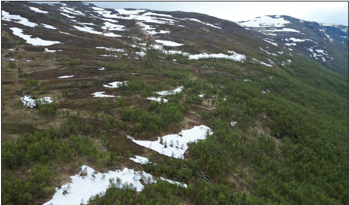
Figur 15: I påvirkningsområdet er det en markant overgang fra slakt til brattere terreng ved skoggrensen, og et større areal drenerer ned mot kartleggingsområdet. I forsenkninger og bekkeløp har vi identifisert løsneområder for sørpeskred og stedvis også flomskred. Bildet er tatt med drone og ser mot sørvest. Bekkeløpet som ses ca. midt i bildet er løp sørvest for Storelva.
