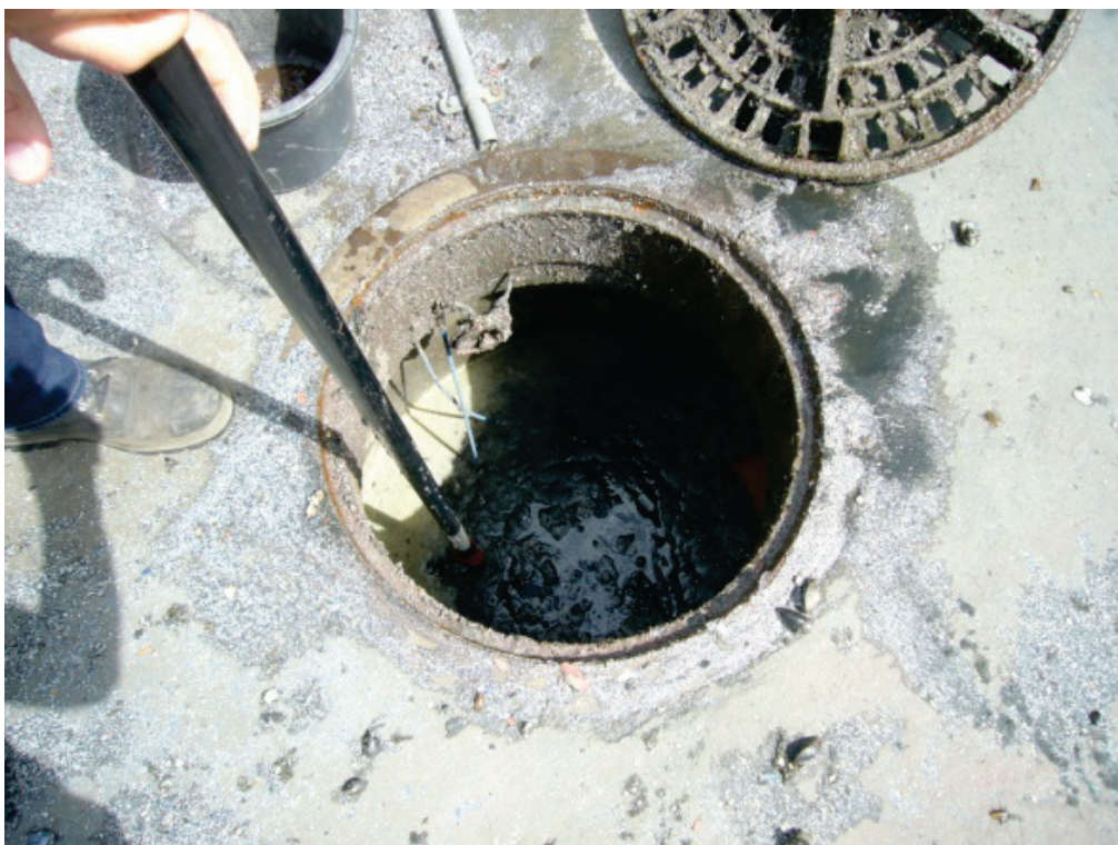
Figur 2 Prøvetakning av sandfangskum (prøve av kategori 1) som samler opp faststoff fra høytrykksspyling av båtskrog. Foto fra Blommenholm båtforening.
