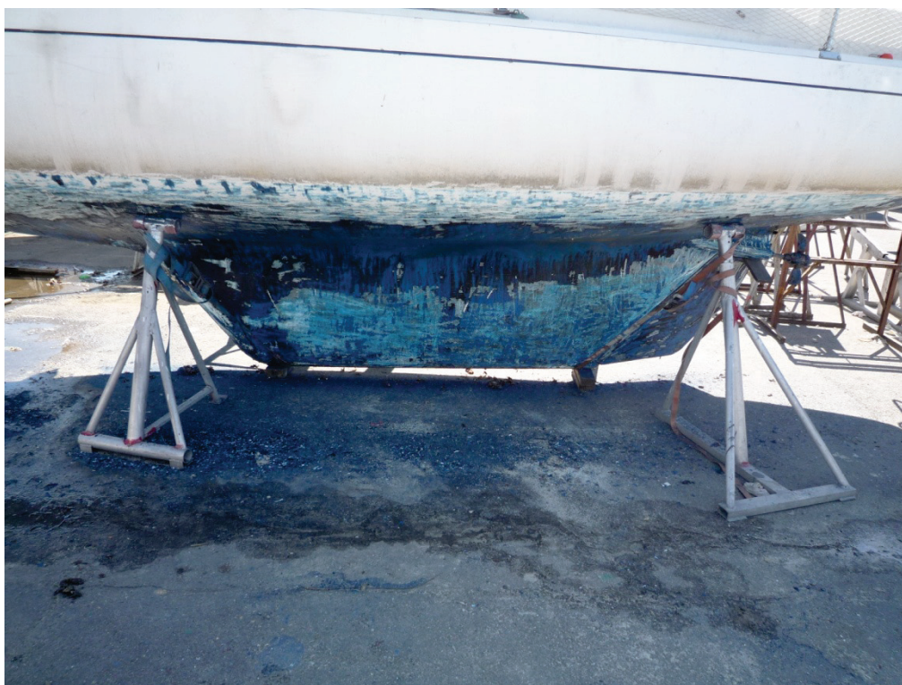
Figur 9 Skraping av skrog uten bruk av presenning på tross av båtforeningens reglement
