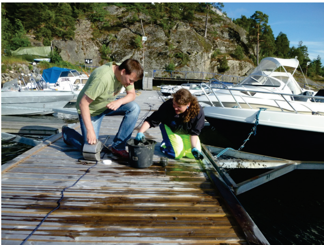
Figur 7 Prøvetakning av sjøsediment (både kategori 3 og kategori 4 prøver) ble utført ved bruk av Van Veen grabb. Foto fra Kambo marina.
