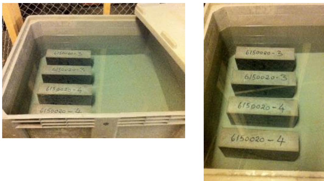
FIGUR 6 LAGRING AV BETONGPLATER I S.LAB, I KAR MED SJØVANN. TO PLATER FRA HVER BETONG. FOTO: ØYVIND BJØNTEGAARD, STATENS VEGVESEN
