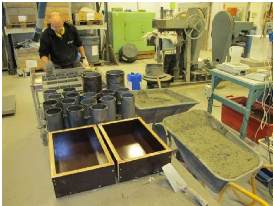
FIGUR 1 FØR STØPING AV PRØVER (SINTEF). FOTO: ØYVIND BJØNTEGAARD, STATENS VEGVESEN.
