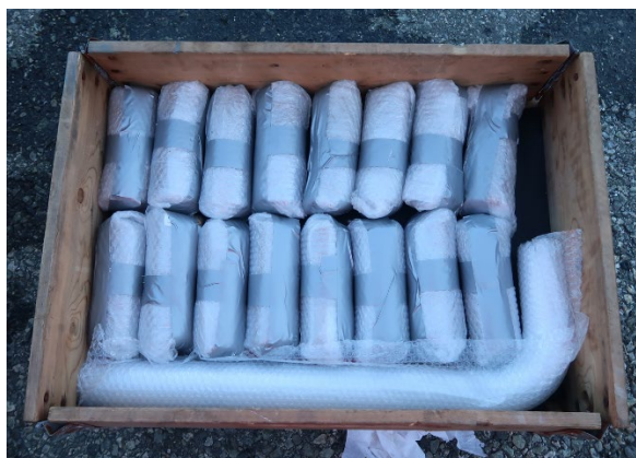
FIGUR 15 TIL VENSTRE: PLASTINNPAKKEDE OG MERKEDE KJERNER, TIL HØYRE: PALLEKASSE MED ALLE KJERNENE PAKKET I BOBLEPLAST, KLAR FOR FORSENDELSE TIL SENTRALLABORATORIET I OSLO. FOTO: EVA RODUM, STATENS VEGVESEN.
