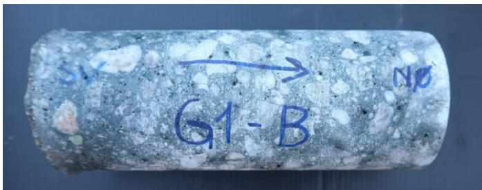
FIGUR 14 EKSEMPEL PÅ MERKING AV KJERNE. KJERNEN ER BORET UT FRA ELEMENT G1, BUNN (NEDDYKKET SONE). FOTO: EVA RODUM, STATENS VEGVESEN.
