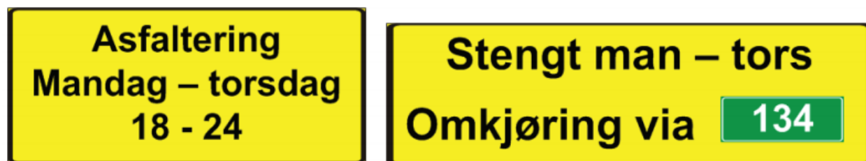
Figur 3.2.5—7 — Eksempler på skilt 560, arbeid på samme veglenke
