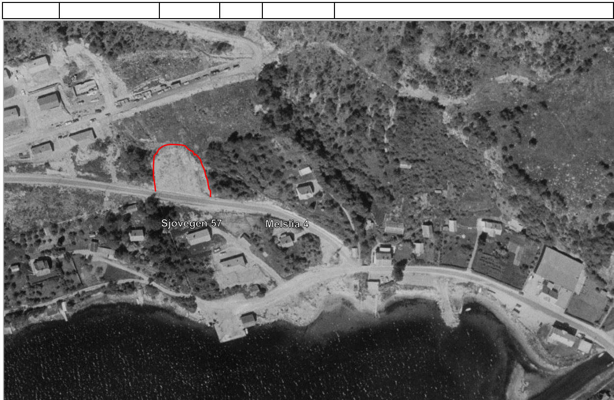
Figur 55. Flybilde tatt 08.06.1976. Skredgropen fra jordskredet ses over Sjøvegen 57. Antatt omriss av utløp kan ses i registreringskart (vedlegg 5C).
