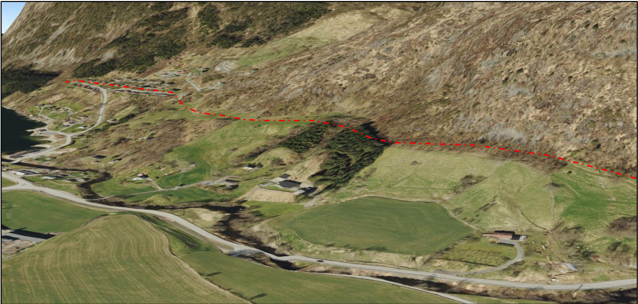
Figur 57. Utsnitt fra 3d-modell over delområdet Melslia. Overgang mellom tykkere avsetninger og tynnere/manglende avsetninger over (tynn morene/skredavsetninger/bart berg) er markert med rød linje, denne sammenfaller med marin grense (ca. 50 moh.) i området.
