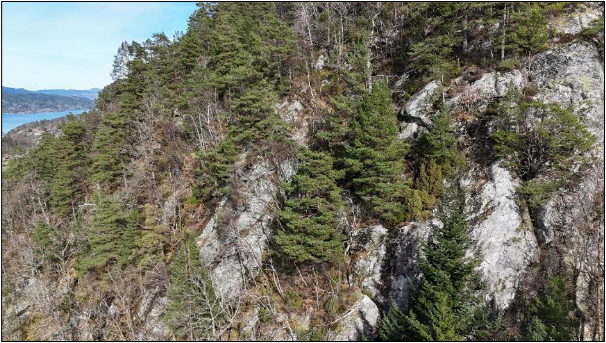
Bilde 7. Detaljbilde av bergskrent over Nesvegen 184. Bergskrent er formet av rundete gamle flater, men det kan observeres noen avløste blokker i øvre del av skrenten. Blokkene ligger på slake plan. Bildet er tatt mot sørøst.
