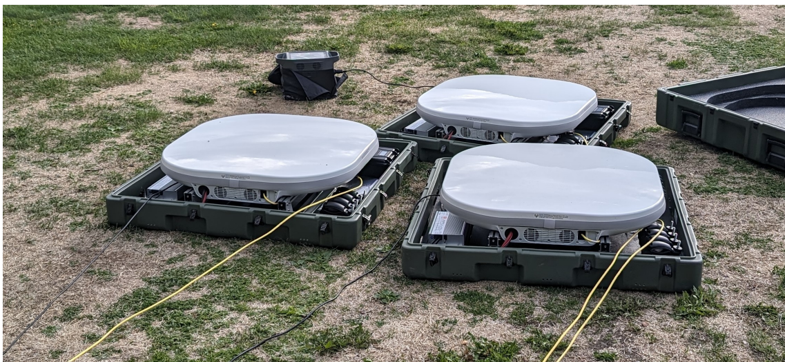
Figur F.1 Tre satellitterminaler fra Kymeta av modellen Hawk u8 LEO som fungerer med OneWeb sin satellittjeneste.
