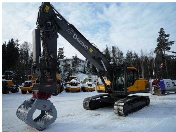
Figur 28. Gravemaskin med sorteringsklype
