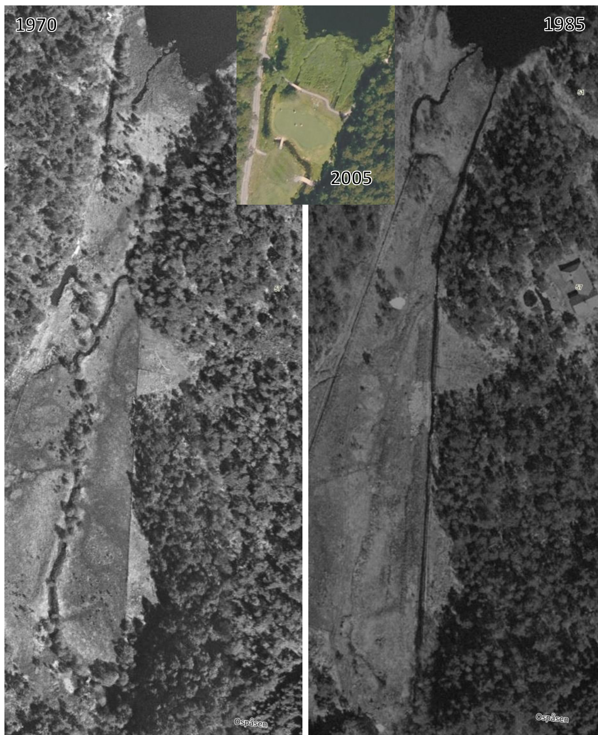
Figur 96. Utretting og kanalisering av elveløpet ovenfor Steinsvikvatnet, utrettingen skjedde en gang i perioden 1974 til 1980, elveløpet på strekningen er redusert fra 446 til 361 m. I nedre del hadde elveløpet allerede i 2005 blitt tilbakeført til sitt opprinnelige elveløp, innfelt bilde i farge.
