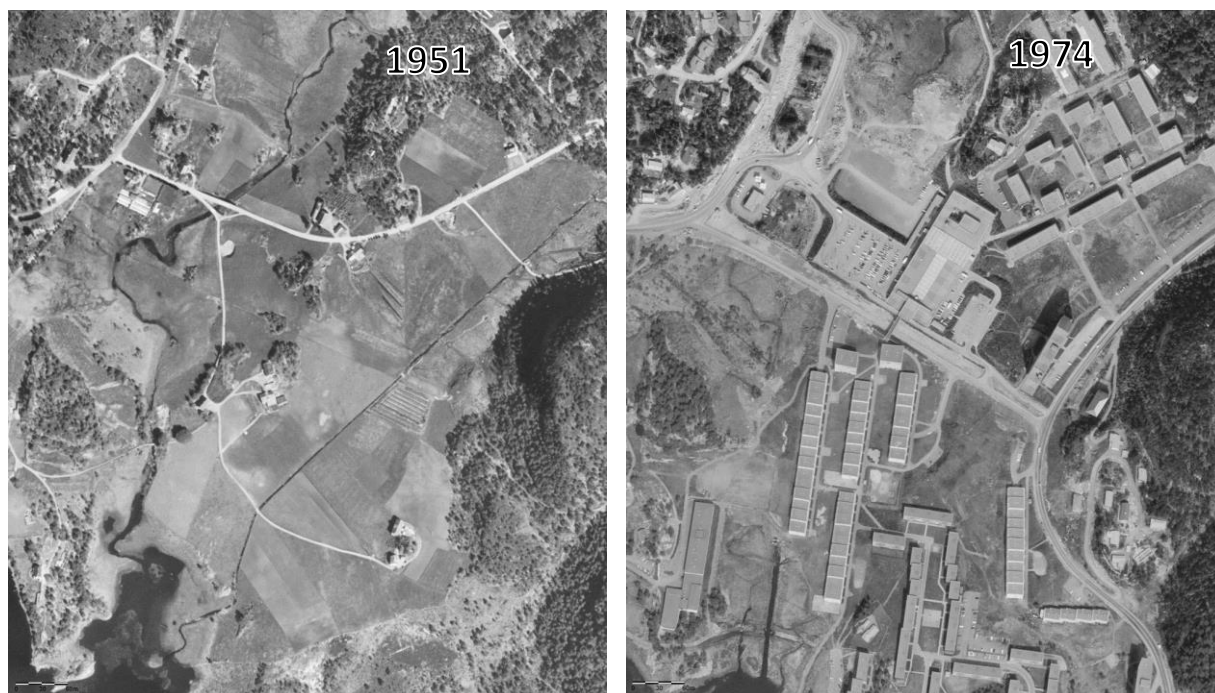
Figur 110. Orttuelven ovenfor Orttuvatnet i 1951 og i 1974. Orttuvatnet, som skimtes nede til venstre i bildet er senket, den nederste delen av elven er kanalisert og det meste av hovedelven og sideelven mot nordøst er lagt i kulvert eller rør.
