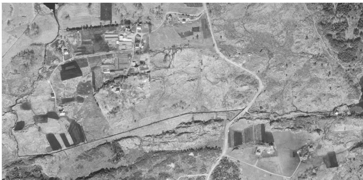
Figur 87. Flyfoto av Ådlandsbekken fra Ådlandsvatnet til utløp i sjøen tatt i mai 1951. Den lange kanaliseringen oppstrøms Hjeltestadvegen (til venstre i bildet) vises tydelig. Jordbruksaktiviteten var større på den tiden og det var mindre kantvegetasjon enn det er i dag.
