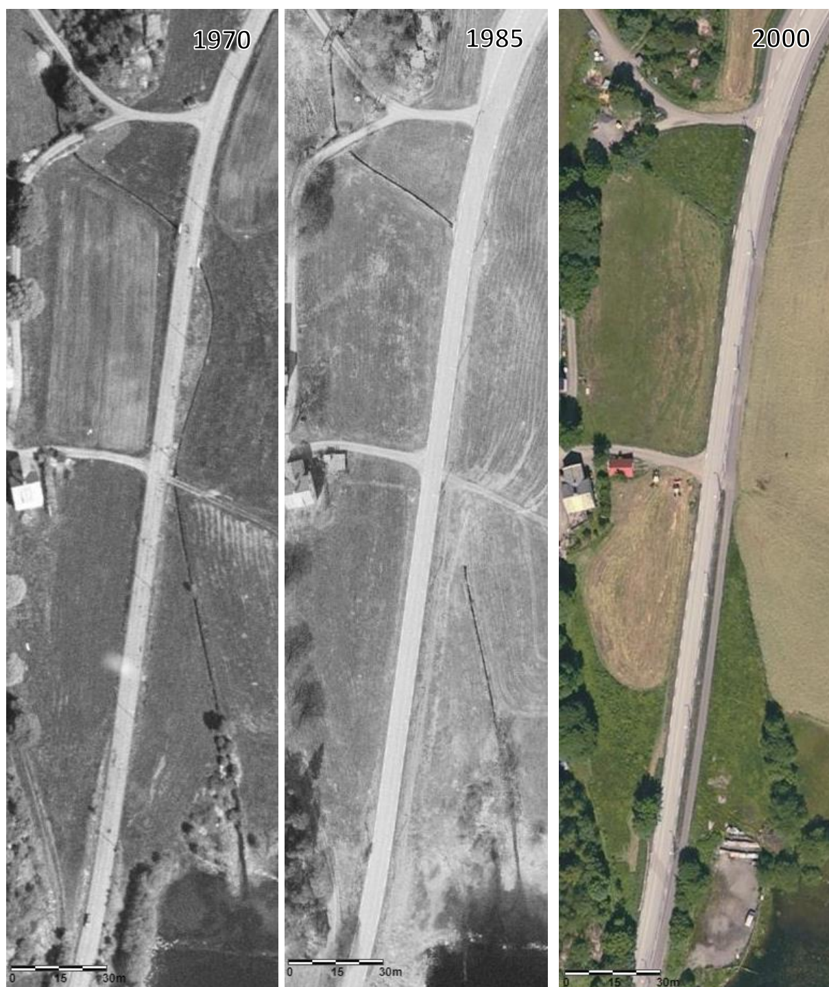
Figur 70. Flyfoto av Breivikbekken fra Storavatnet 290 meter nedover tatt i 1970, 1985 og i 2000. Av elven ble 100 m langs Krokeidevegen lagt i rør en gang mellom 1970 og 1985. Den 20 meter lange strekningen mellom de to delene av Botnagrendavegen ble lagt i rør en gang mellom 1985 og 2000. Ut fra bildene kan en tydelig se at elven har vært gjenstand for betydelig kanalisering og utretting, dette skjedde før 1950 (kilde: Norgebilder.no).
