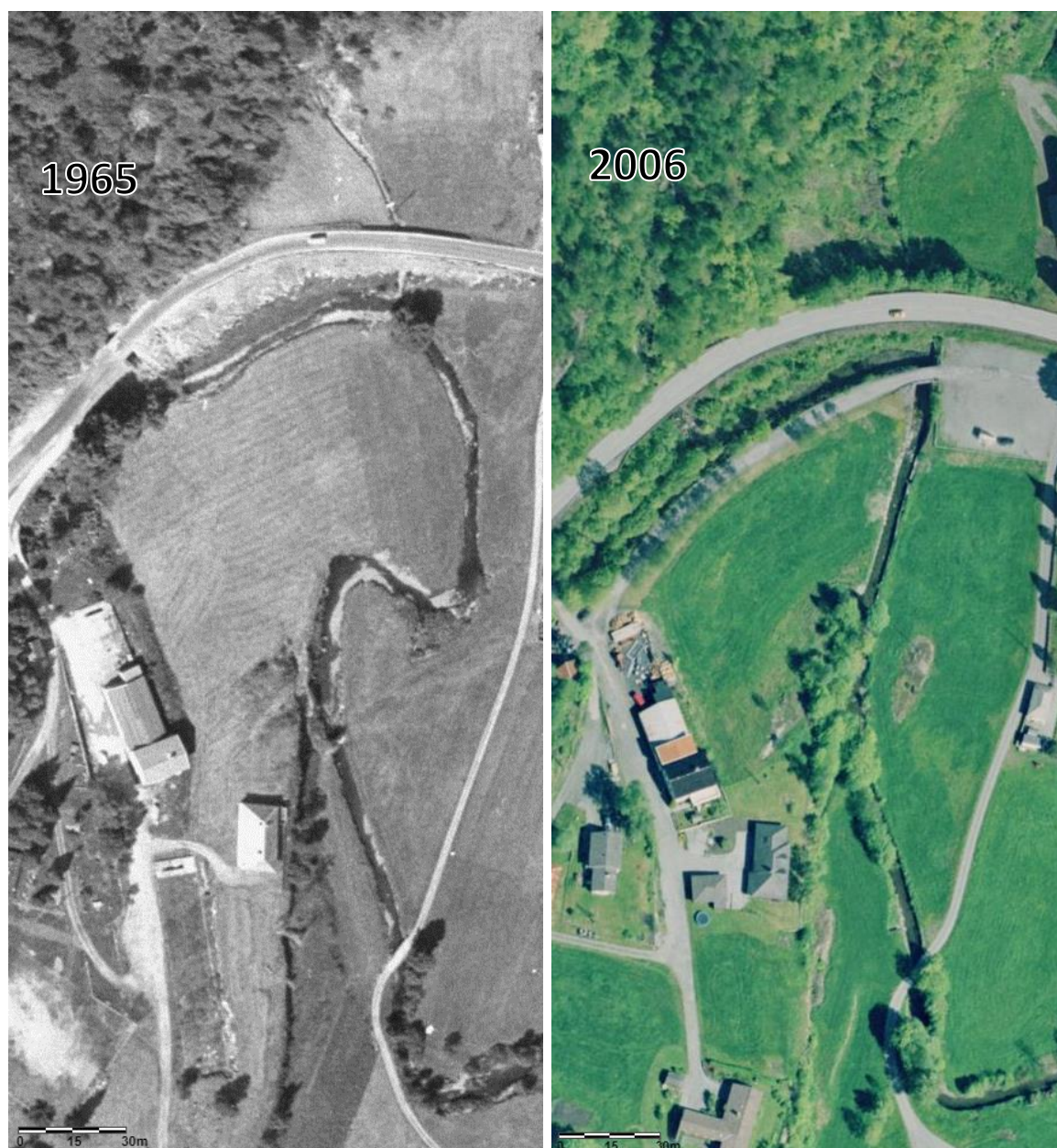
Figur 44. Flyfoto fra nedre del av Ådlandselva (segment 4-11, og 17). Elven ble både kanalisert og utrettet på dette partiet en gang mellom fra 1973 og 2006. For den utrettete strekningen midt på bildet ble elveløpet forkortet fra 120 til 75 meter (Kilde: norgebilder.no).
