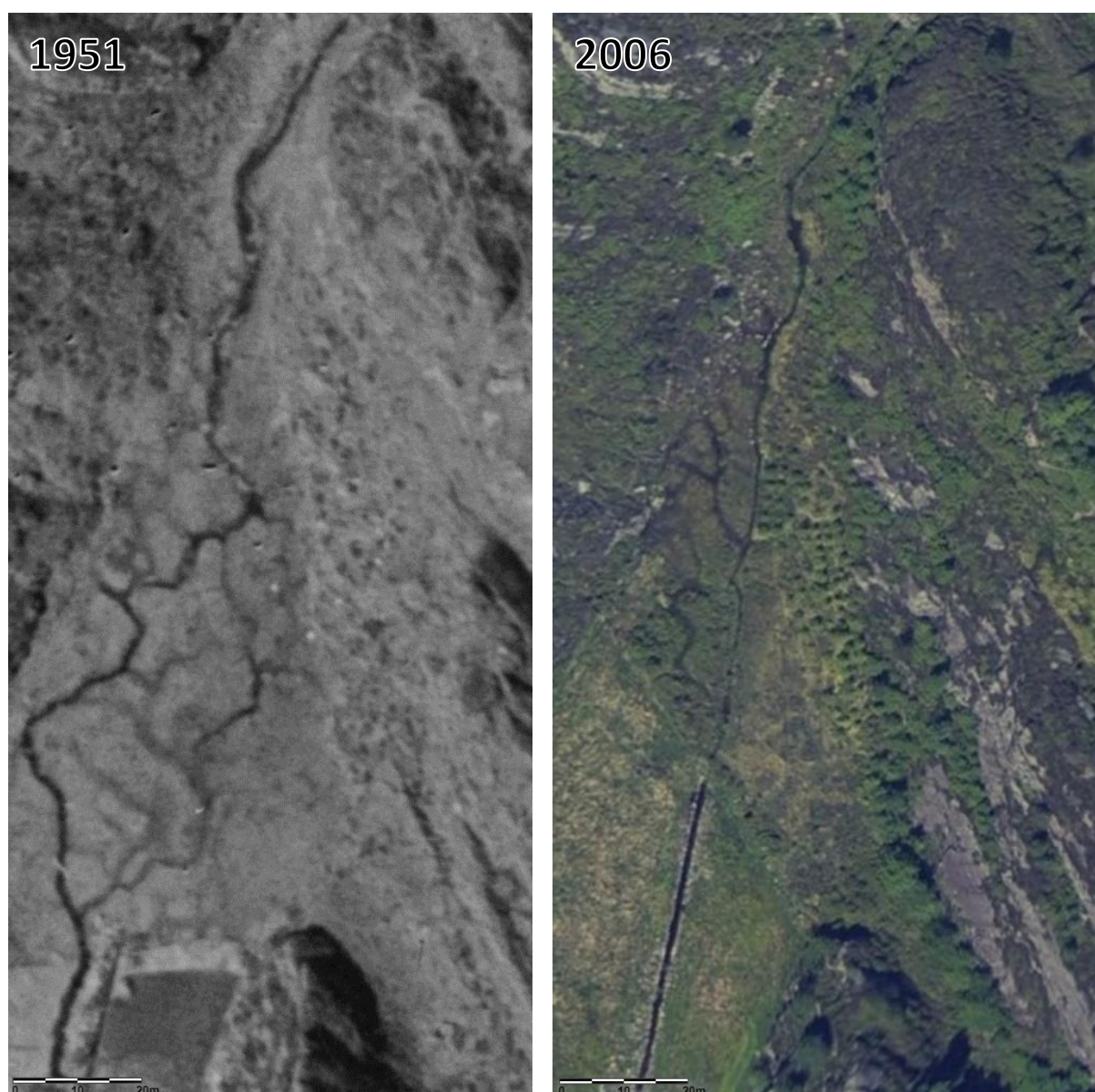
Figur 157. Flyfoto av Fauskangerbekken nedstrøms Stemmevatnet tatt i 1951 og i 2006 (kilde: Norgebilder.no). På den utrettede strekningen har elven gått fra 151 til 120 meter, altså en forkortning på 20 %.
