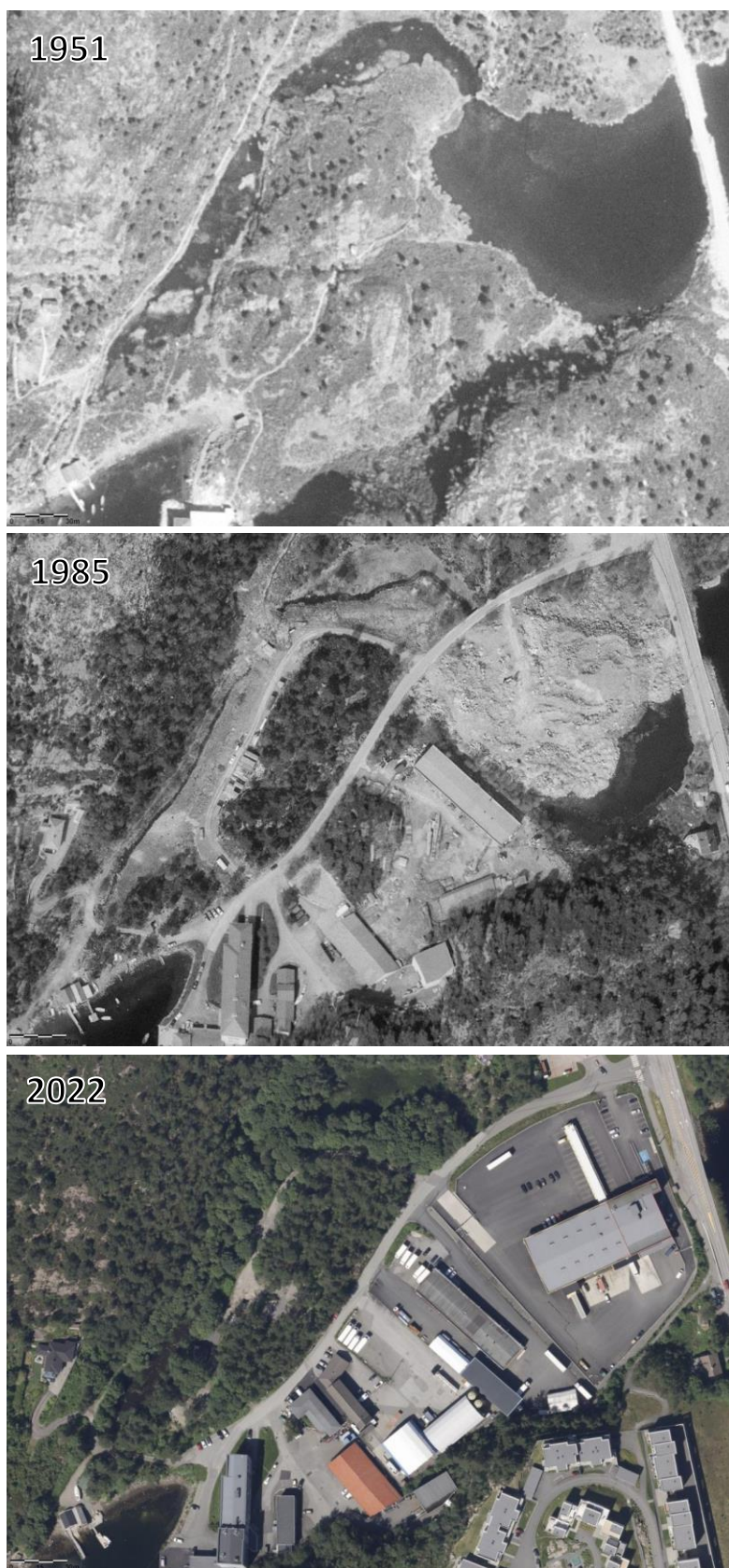
Figur 126. Flyfoto av vestre del av Gjeddevatnet og Kjerreidbekken. På bildet fra 1950 er elven tilnærmet urørt, mens i 1985 er store deler av Gjeddevatnet vest for Bjørgevegen fylt igjen og elven er kanalisert. Elven ble tilbakeført til sitt opprinnelige elveløp på 1990-tallet.
