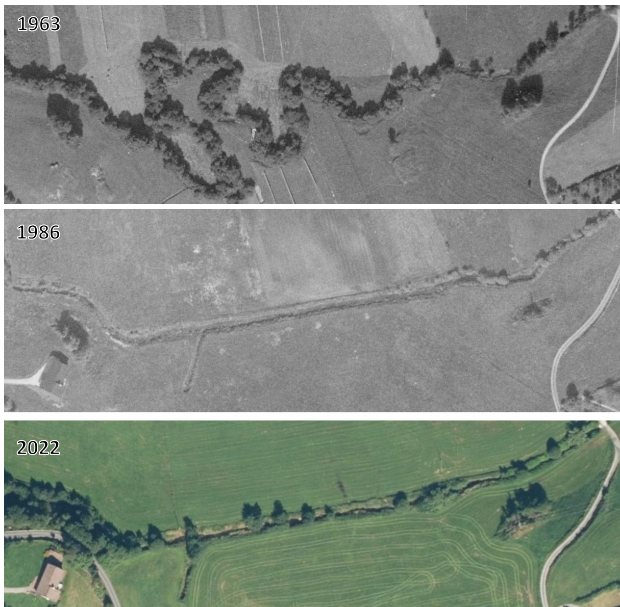
Figur 7. Utretting og kanalisering av nedre del av det vestre elveløpet. Utrettingen skjedde en gang i perioden 1963 til 1986, elveløpet på strekningen er redusert fra 577 til 297 m. Etter at elveløpet var utrettet var det meste av kantvegetasjonen fjernet, denne er nå delvis kommet tilbake.
