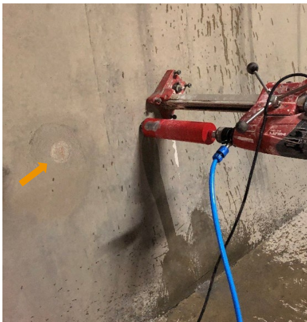
Figur 14 Utboring av kjerner i 2020, høyde ca. 0,8 m over bankett. Reparert borhull fra 2015 til venstre på bildet (merket med pil). Foto: Stig Henning Helgestad, Statens vegvesen
