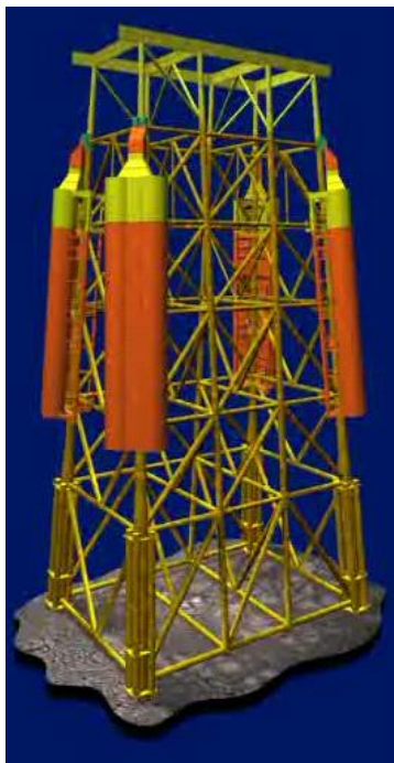
Figur 11.9: Utvikling av ny fjerningsteknologi, oppdriftstanker som festes til stålundestell som skal fjernes (kilde: Aker Kværner)
