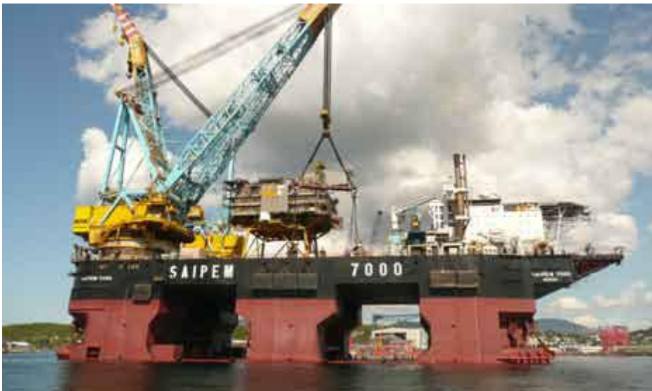
Fig 11.2 Saipem 7000 ankommer Stord med toppdekk fra Frigg QP
