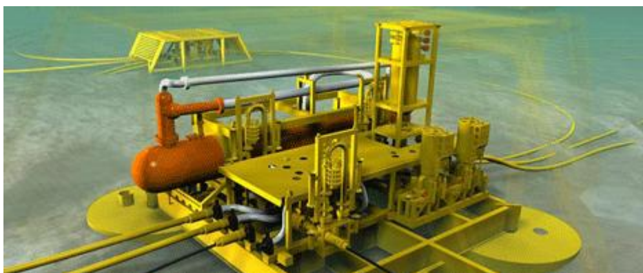
Figur 4.2: Havbunnsseparasjon system, Tordis (kilde: Statoil)
