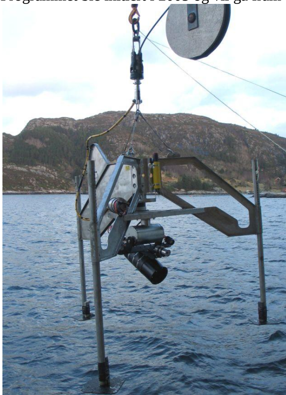
Figur 8.2: CAMPOD – mobilt undervannskamera for fotografering av sjøbunnen
