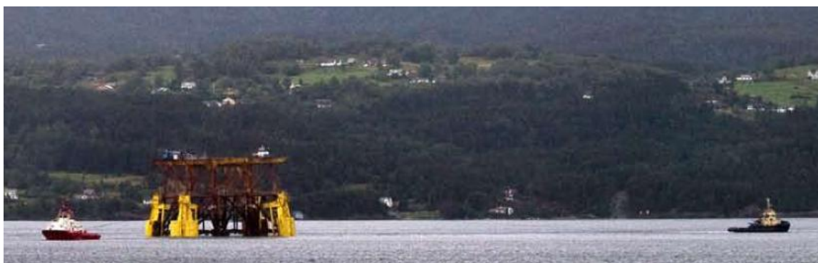
Figur 11.10 Frigg DP2 Jacket slepes til Stord ved hjelp av bl.a. oppdriftstanker (kilde: Total)
