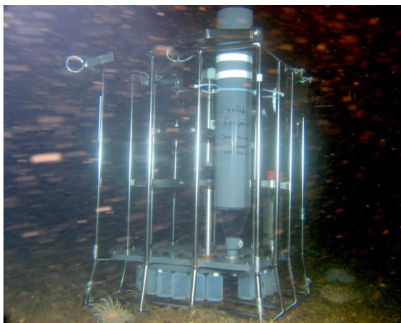
Figur 8.1: Bildet viser en bunnramme (lander) hvor ulike sensorer er montert for overvåking av miljøparametre. Denne er plassert ved et dypvanns korallrev.
