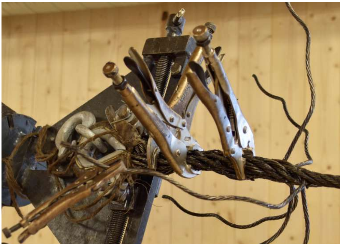
Figur 76 Sveisetenger ble bruk underspleisingen for å holde de spleiste kordeler på plass og for å få tak på den spleise kordel når den skulle dras til. (foto: HFS)
