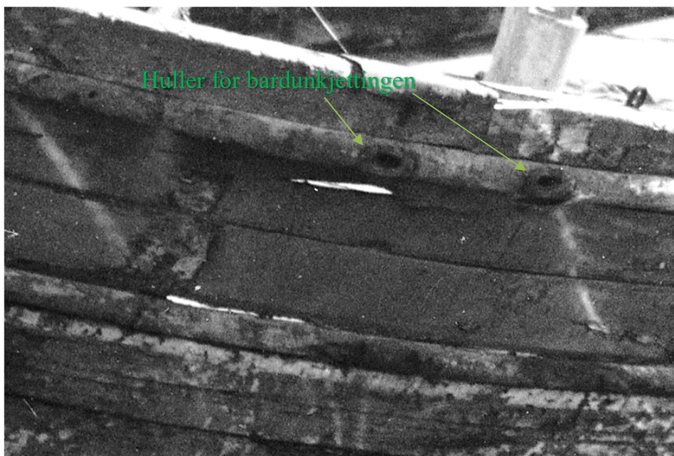
Figur 58 Utsnitt av foto tatt av Anders Wallevik. På vraket av jakt Haabet ser vi beslagene rundt hullene der bardunkjettingene går gjennom topprekka. Under skandekket ser vi også at det er rester av den hvitmaltte stripen, og midt på planken er det til og med risset inn en staff. Vi ser ikke bort ifra at også denne har vært malt.
