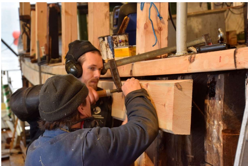
Figur 22 Erik Sunde Apelthun og Terje Skorpen monterer den øverste hudplanken, råholtet, eller målargongen som den heter på dialekten her i Hardanger.
