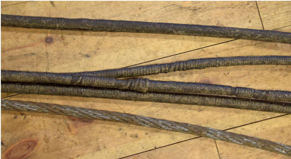
Figur 53 (foto: HFS) Kledningen på fotpertene og bardunene var åpne flere plasser.
