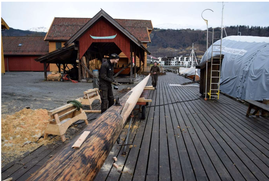
Figur 48 Under vedlikeholdet av masta ble det oppdaget store råteskader i mastetoppen. En ny topp ble straks laget.
