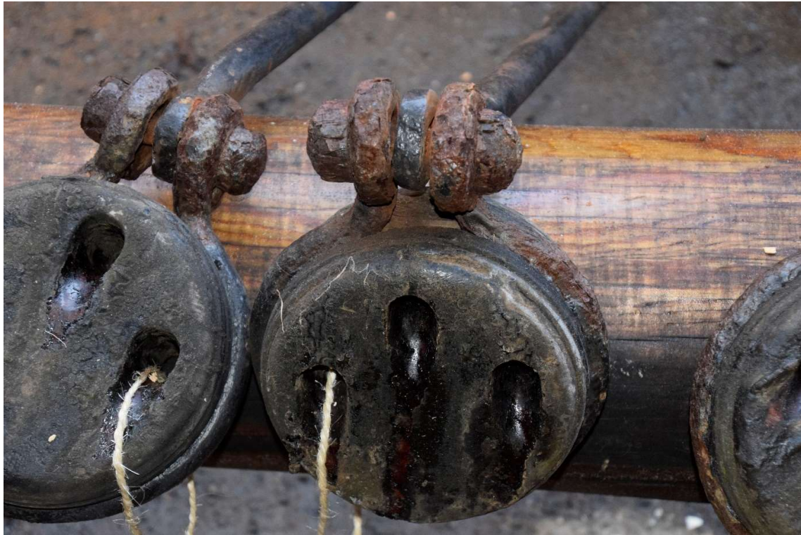
Figur 50 Rust var det også på jomfrubeslagene. Vi laget nye røstjern og jomfrubeslag, og de ble utført med et tidsriktig utseende.
