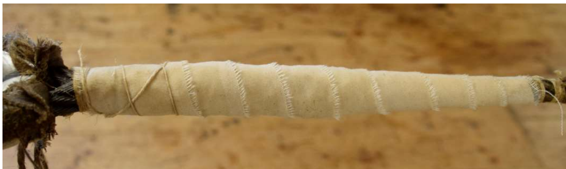
Figur 82 Her skal øyet stå oppetter og smertingen er lagt rundt spleisen nedefra og opp mot øyet. (foto: HFS)
