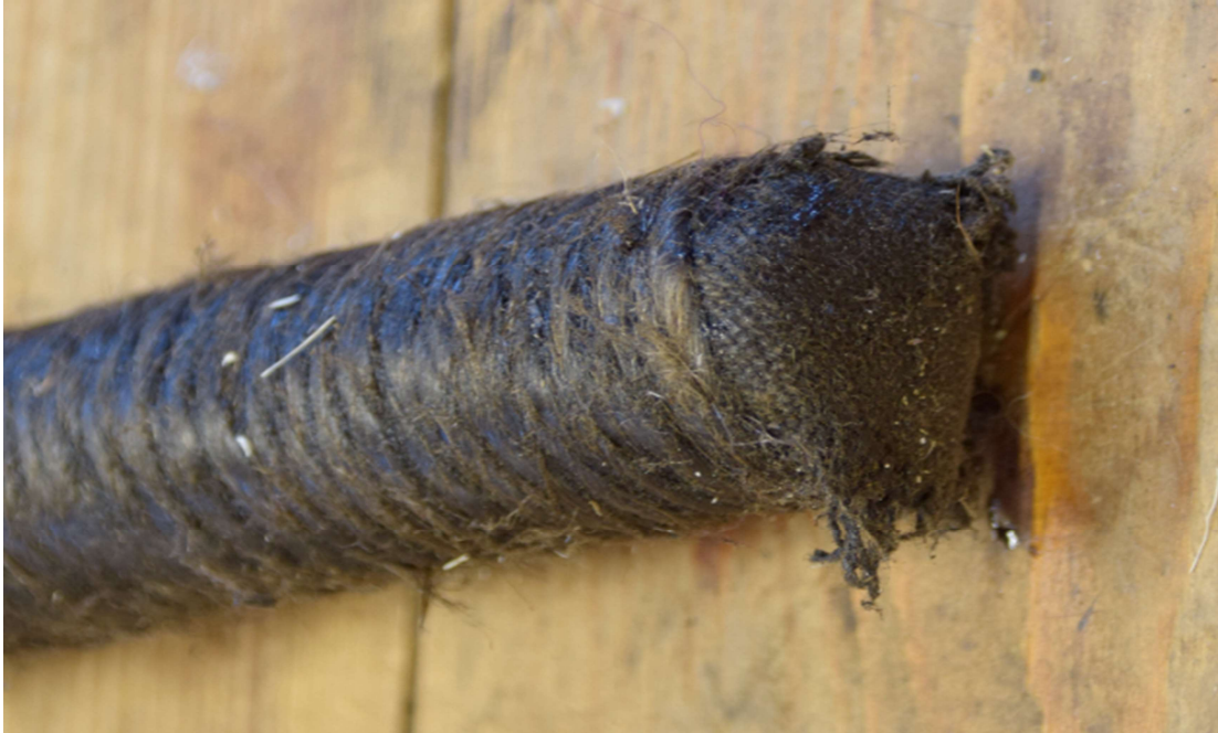
Figur 86 Smertingen er foldet rundt enden av wiren før den er kledd helt til endes. (foto: HFS)
