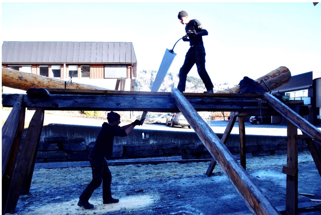
Figur 42 "Og sola fell på deg, mens skuggen fell på meg" ... Brødrene Jens og Mads Rubin Mauritsen kløyver en stokk som passer perfekt til svinerygg. Ved å kløyve den fikk vi ut svineryggen til både styrbord og babord side ut av samme stokken.
