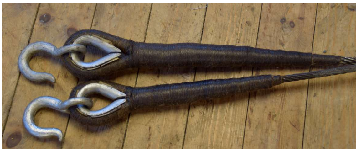
Figur 73 Jagerleider (nederst) ble omarbeidet og spleist på ny mens klyverleider ble skiftet ut. Begge fikk dobbel kledning i øye og over spleis, og ble utstyrt med kause med krok. (foto: HFS)
