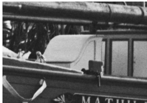
Figur 14: Nedgangskappe med «kinavipp» over skipperlugar, her representert ved jaktene "Vega" og "Mathilde", ser ut til å være Ola. H. Nerhus sin signatur. Dagens nedgangskappe på «Mathilde» følger hovedkurven ned til bunns.
