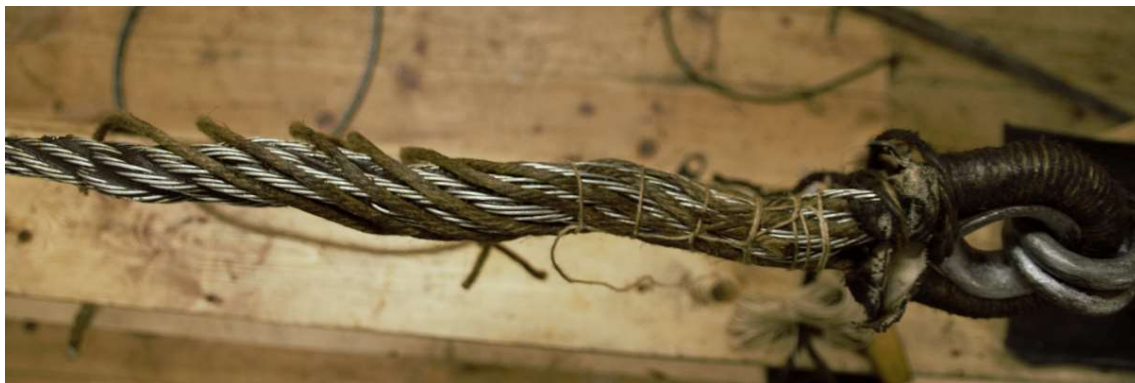
Figur 78 Første del av vorming hvor fauten fylles ut. (foto: HFS)
