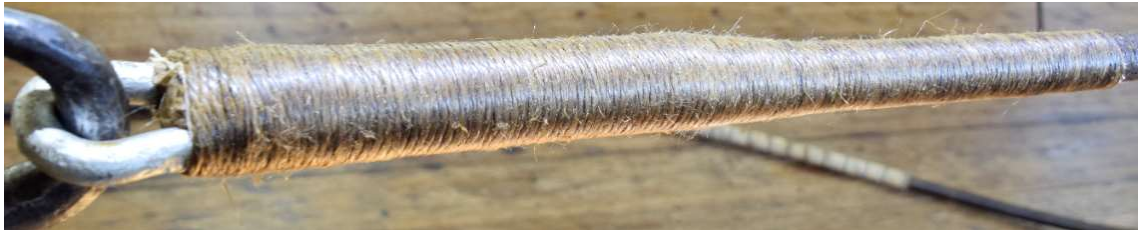
Figur 95 Doppskoen ferdig kledd. (foto: HFS)
