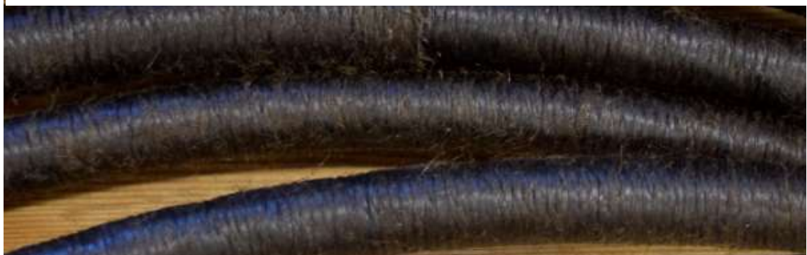
Figur 98 Lensetakkelen ble full kledd med to lag på midten. (foto: HFS)
