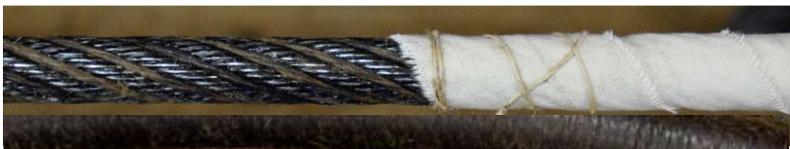
Figur 97 Ny lensetakkel ble vormet og der etter smertet og kledd. På midten, der den ligger rundt masten og en bit ned forbi, ble den smertet og kledd enda et lag. (foto: HFS)
