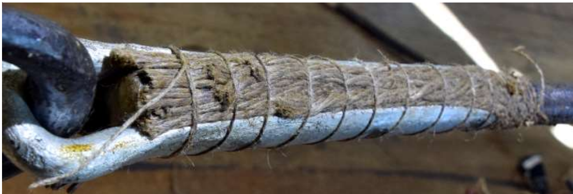
Figur 92 Det nedsenkede området mellom benene på doppskoen fylles med sjømannsgarn. (foto: HFS)
