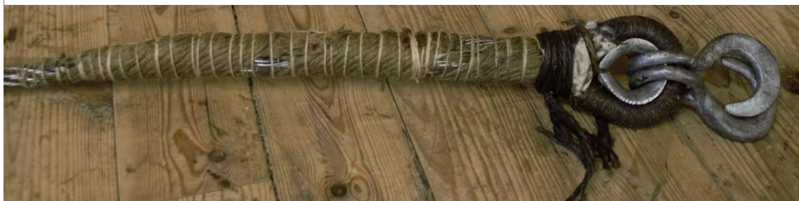
Figur 80 Vorming surres godt faste med seilgarn. (foto: HFS)
