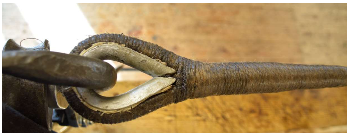
Figur 85 Når kledningen i øyet ikke går ned forbi skrevet vil kledningen fra spleisen kunne gå høyt nok til at det blir helt tett med krysstørnene. (foto: HFS)
