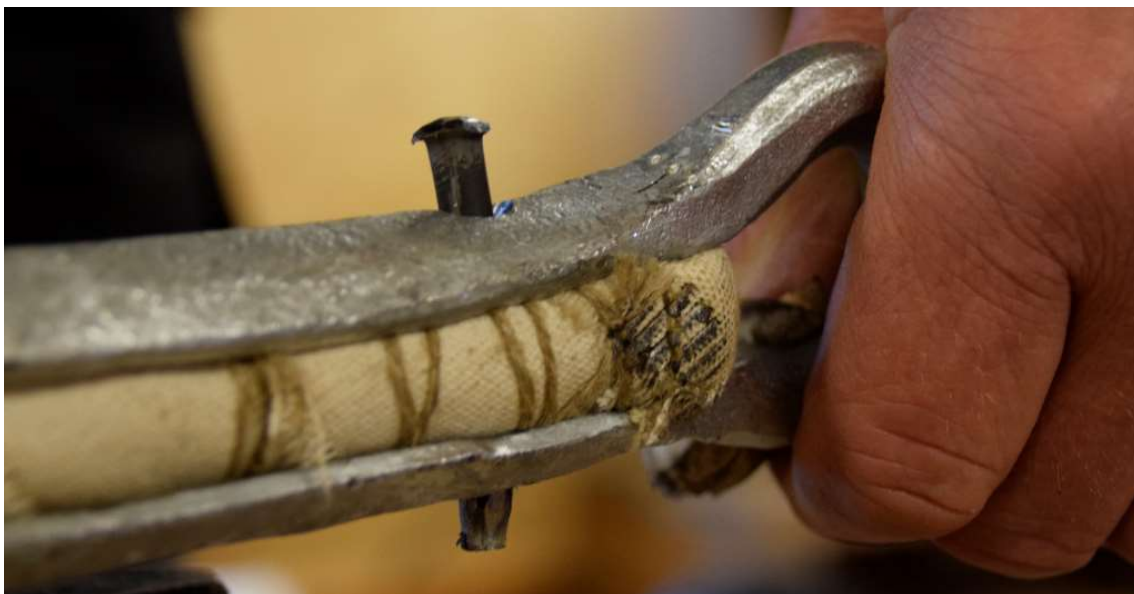
Figur 89 Innen boltene drives helt nedtil klinkes et hode på den. Det er en fordel at det er laget en liten forsenkning rundt hullet, slik at ikke hodet stikker opp når det er ferdig. (foto: HFS)
