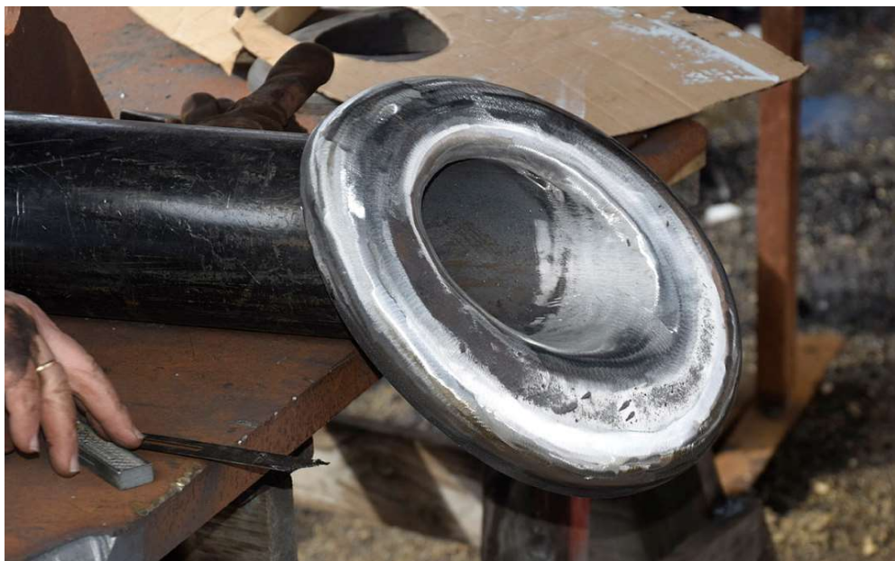
Figur 40 Peder Furuberg har sveist og slipt slik at det nye klysset ligner det man ville fått om det var støpt.
