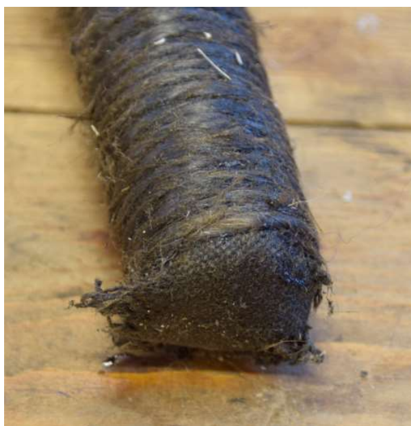
Figur 99 Smertingen ble lagt rundt enden av lensetakkelen etter og kledd. (foto: HFS)
