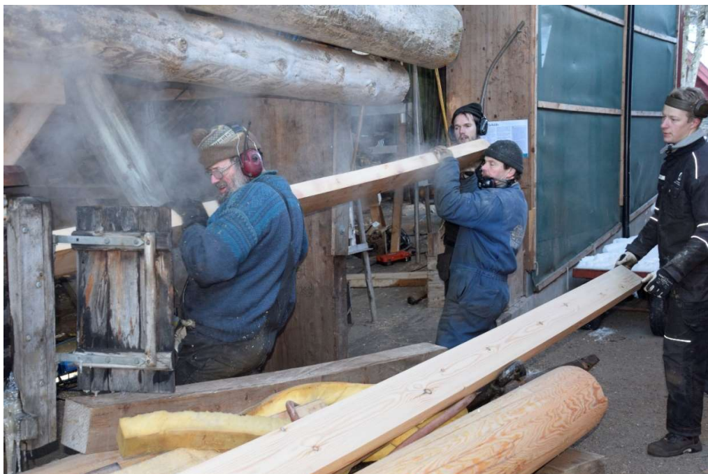
Figur 21 Her var ingen hvile å få. Straks spantene og innerstevnen var ferdig begynte vi å kle opp "Mathilde" med gode nye furumaterialer. Der «Mathilde» hadde runde former måtte plankene steames for å være føyelige nok til å legge seg inntil spantene.
