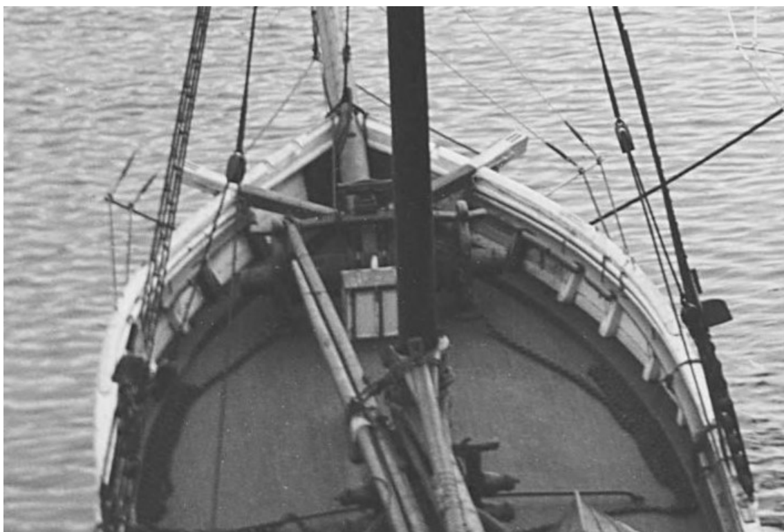
Figur 39 Utsnitt av foto tatt av Anders Beer Wilse, Kristiansund 1897. Funnet på nb.no Her ser vi hvordan naglebenken går over i kryssholter rett ut for nedgangskappa til mannskapslugaren.
