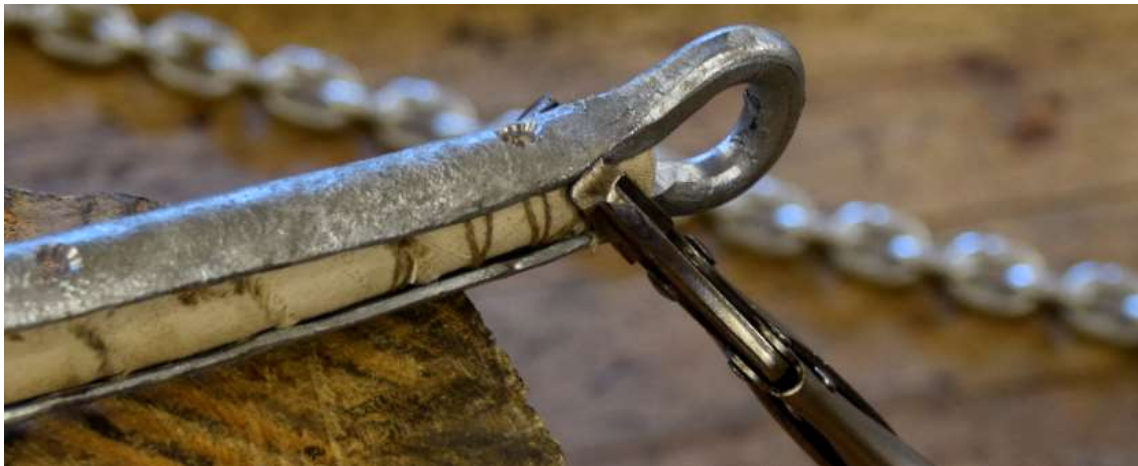
Figur 87 På mindre wire kan det være en hjelp å holde den i posisjon med en sveiseklemme så den ikke forskyver seg til siden. (foto: HFS)
