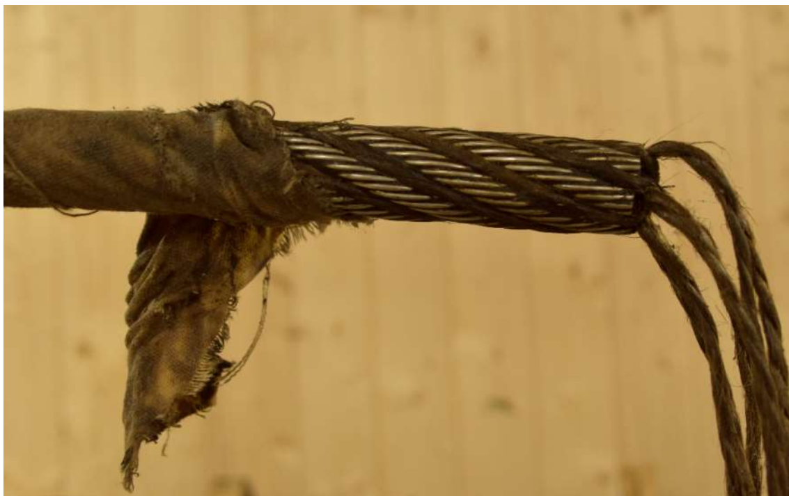
Figur 100 Vorming på lensetakkel gikk helt til enden. (foto: HFS)
