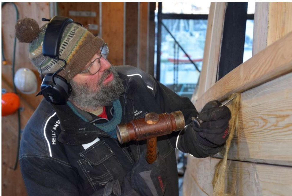
Figur 25 Da alle hudplankene var montert og slettet kunne vi drive skroget. Her er Peder Furuberg i gang med den første tråden. Det drevet vi får kjøpt i dag er av lin, mens det i eldre dager var av det mer råtebestandige materialet hamp. Som et prøveprosjekt tjæret vi en del hampegarn som vi brukte som drev i dekket forut. Så får vi følge med og se om det holder seg bedre enn lindrevet.
