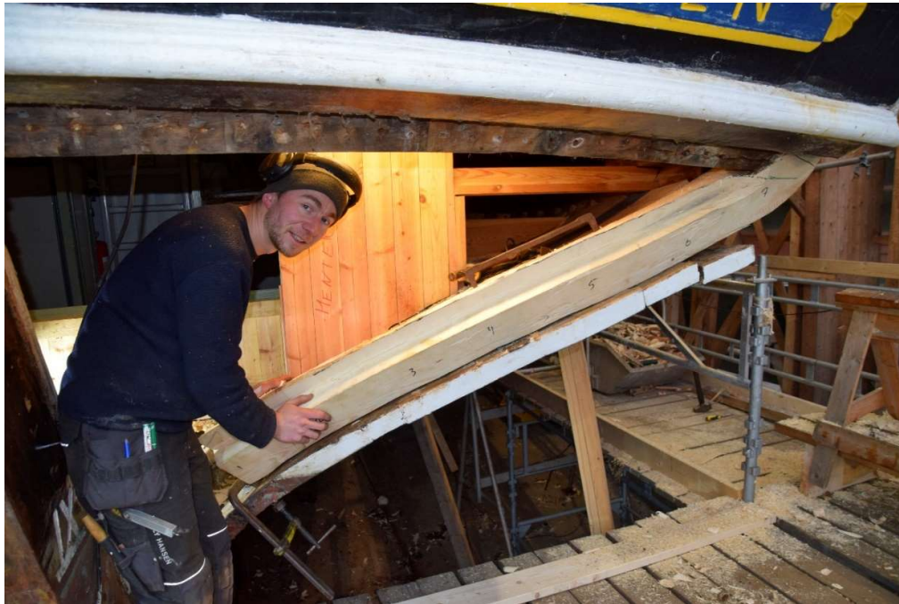
Figur 27 Underspeilet i styrbord side er fjernet og lærling Mads Rubin Mauritsen har laget en ny hukmann som han her prøver på plassen.
