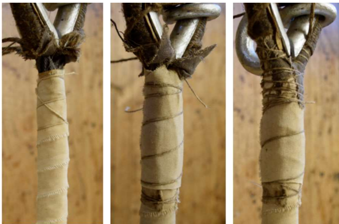
Figur 81 Venstre foto: smertingen lagt om spleisen. Midt foto: En «bleie» er lagt i skrevet og omkring øverste del av spleisen. Høyre foto: smerting fra øyet er lagt opp på bleie og surret godt fast. (foto: HFS)
