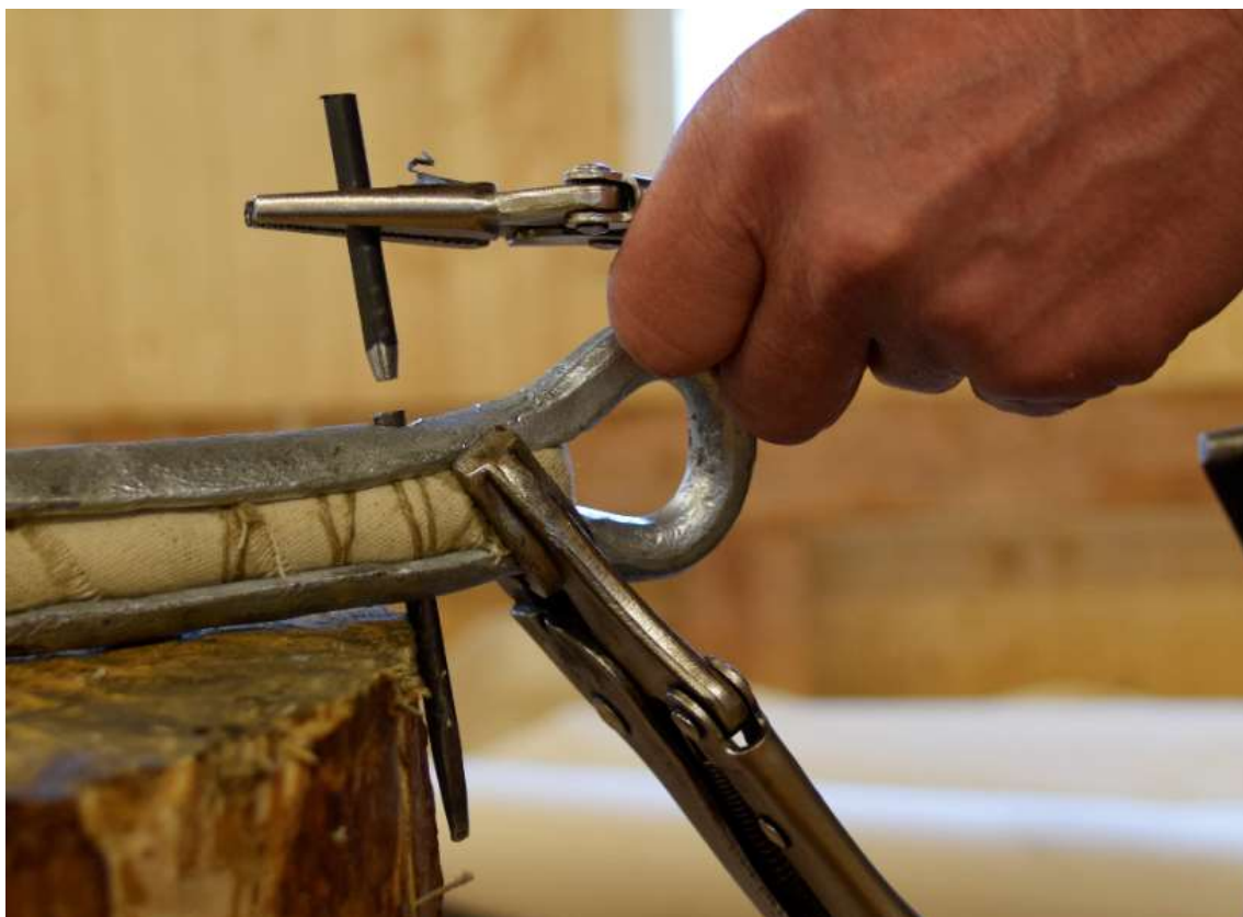
Figur 90 Ledebolten er drevet gjennom og boltene følger på. (foto: HFS)
