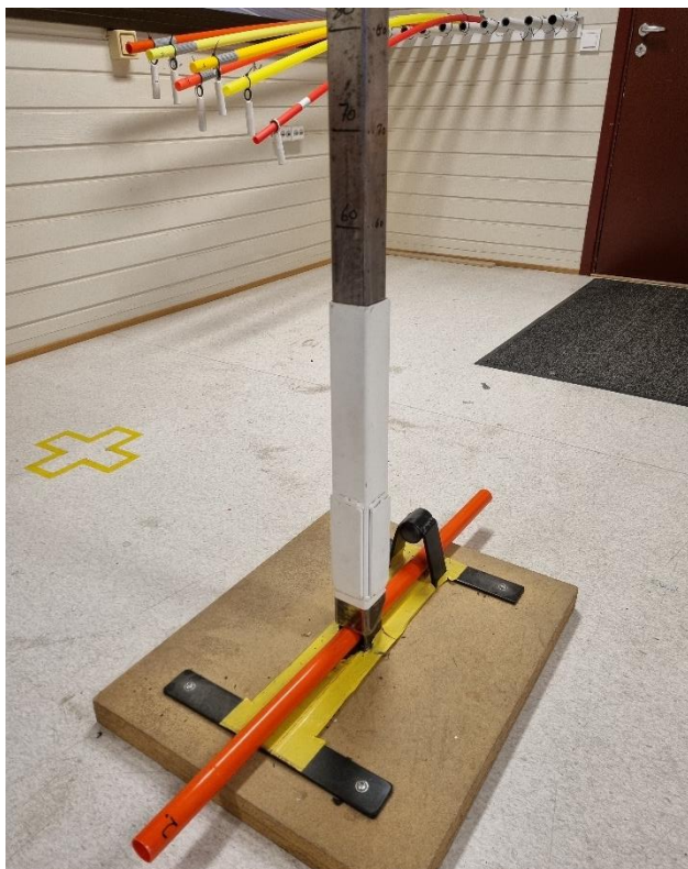
Figur 44: Teststasjon slagtesting ("giljotin")
