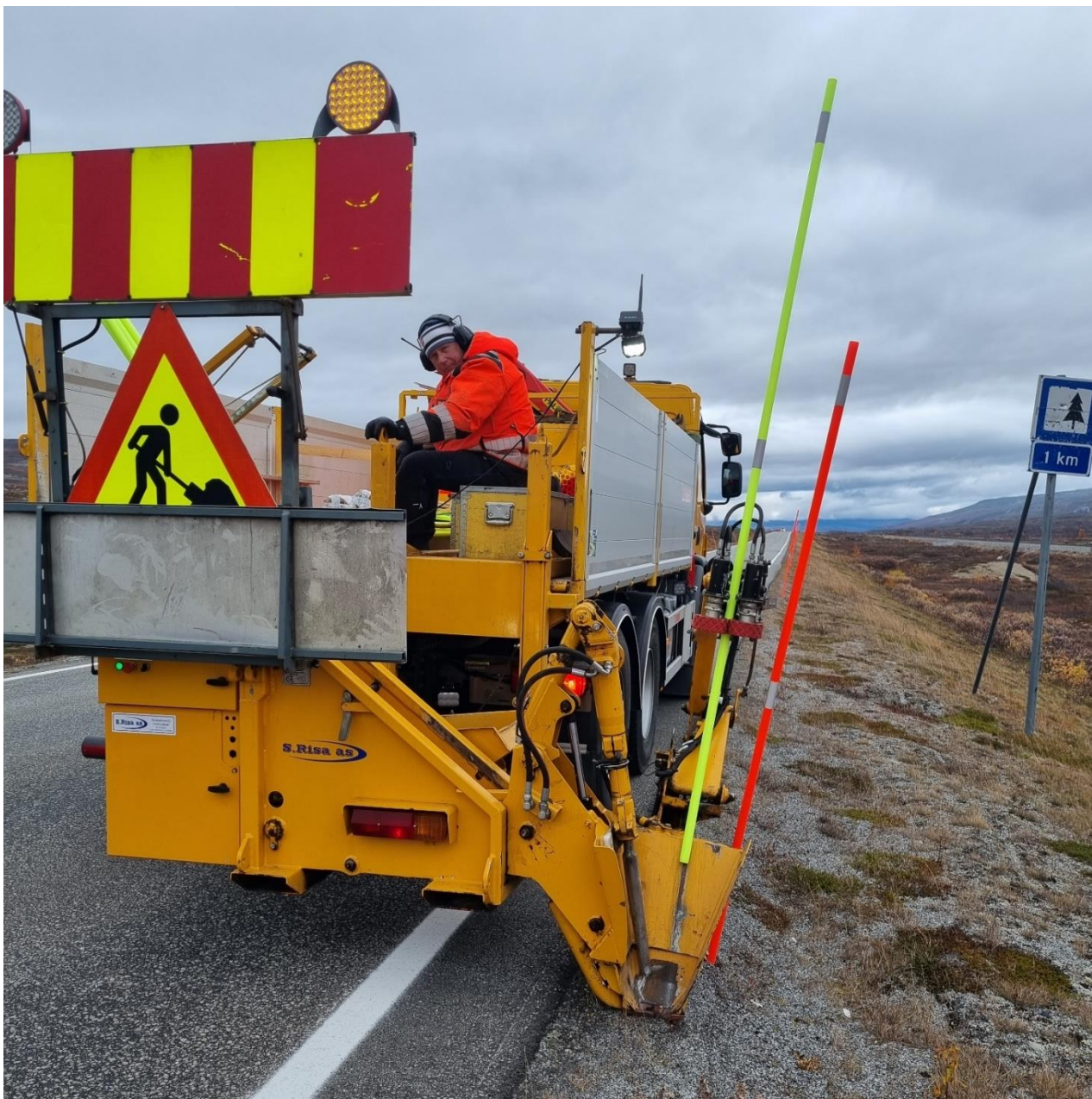
Figur 25: S. Risa Stickset 500 (m/gummihjulshenting/-mating av stikkene) – E6 Saltfjellet 29. september 2022.
