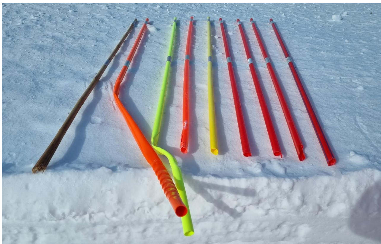
Figur 43: Stikker påkjørt med plogen og brøytet ned. PC stikkene ble ikke kuttet, men i stedet dratt/slitt opp av hullene. Bambus 26/28 mm (f.v.), PC rød_f, PC gul_f, PP rød_f, PP gul_f, PP rød_o, PP rød_o (kl. 3 refleks), PP rød_s og PP rød_s*.
