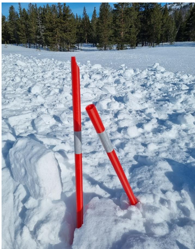
Figur 40: PP rød_s som har gått til brudd.
