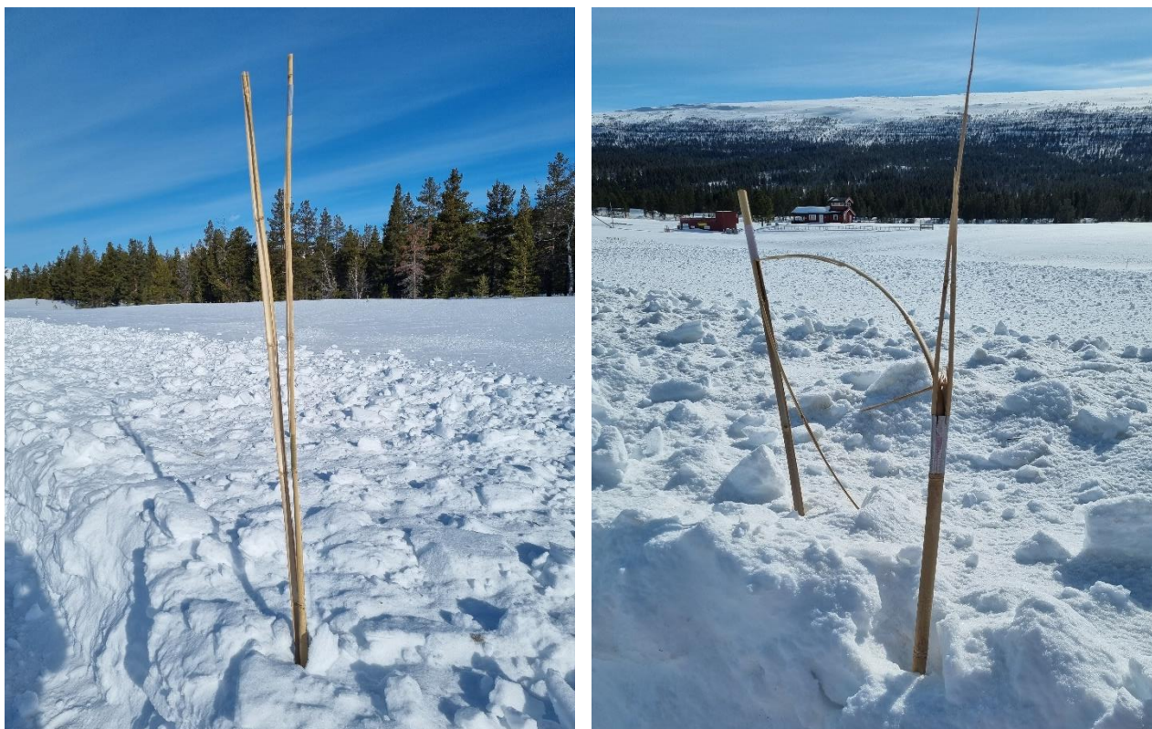
Figur 41: Spjæret og knekt Bambus 26/28 mm.
