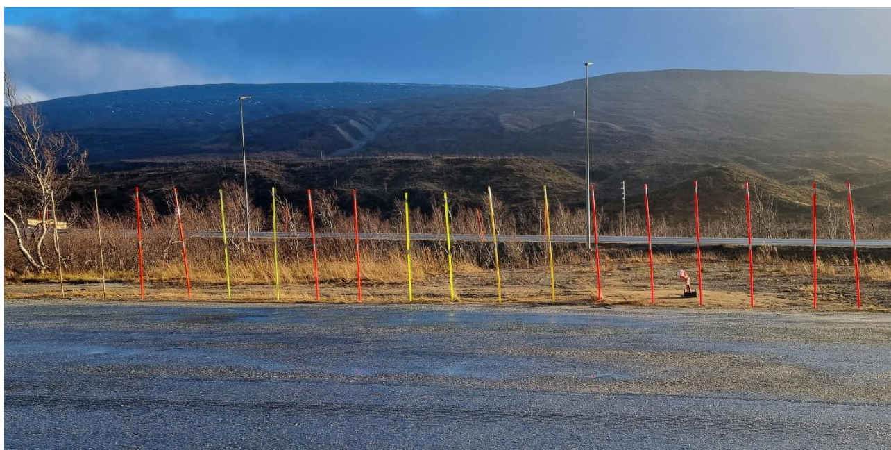
Figur 18: Prøvefelt for langtidstesting ved Sørrelva Brøytestasjon, Saltfjellet. Fra venstre: Bambus 26/28 mm, PC rød_f, PC gul_f, PP rød_f, PP gul*_f, PP gul_f, PP rød_o, PP rød_o (kl. 3 refleks), PP rød_s (to stk stikk av hver type).
