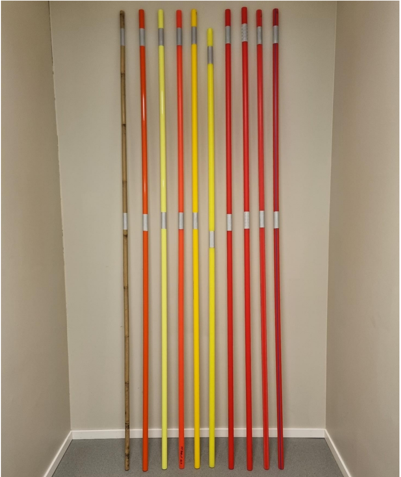
Figur 1: Testede stikketyper vinteren 2022/2023. Bambus 26/28 mm (f.v.), PC rød_f, PC gul_f, PP rød_f, PP gul_f, PP gul*_f, PP rød_o, PP rød_o (kl. 3 refleks), PP rød_s og PP rød_s*.
