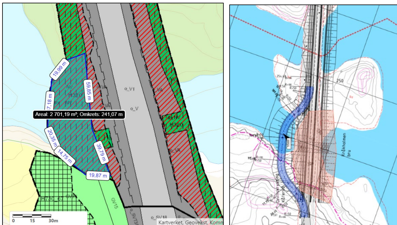
Figur 3.3: Areal ved bru over Svartelva (Kråkholmene sør) der ca. 2,7 dekar regulert til midlertidig arealbeslag (utfylling, anlegge midlertidig veg, fjerning av veg og fylling) ble unngått gjennom endring av planer for bygging og midlertidig trafikkavvikling (blå skravur i utsnitt til venstre). Kilde: Nye Veier AS. Utsnitt til høyre er fra reguleringsplanen.
