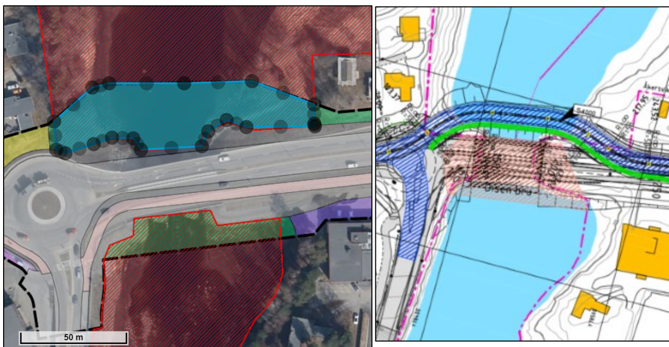
Figur 3.4: Areal ved Disen bru over Flagstadelva (ved Midtstranda vest) der ca. 2,7 dekar regulert til midlertidig arealbeslag (utfylling, anlegge midlertidig veg, fjerning av veg og fylling) ble unngått gjennom endring av planer for bygging og midlertidig trafikkavvikling (blå skravur i utsnitt til venstre). Kilde: Nye Veier AS. Utsnitt til høyre er fra reguleringsplanen.
