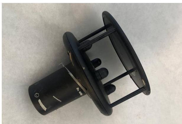
Figur 3.4 Sonde for ultralyd hastighetsmåler. Foto: Håkon Skistad.
