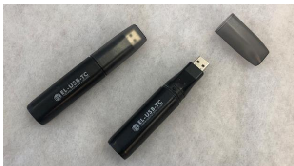
Figur 3.5 Temperaturloggere. Koples til USB-port i en datamaskin. Foto: Håkon Skistad.
