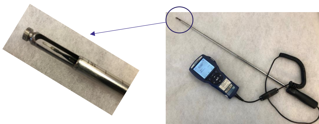
Figur 3.3 Hetetrådsanemometer med instrument som viser hastighet og temperatur. Foto: Håkon Skistad.
