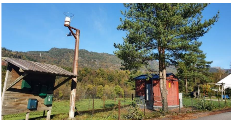
Figur 3.8 Samler for nedfallsstøv i omgivelsene rundt industri, her litt høyere enn standarden tilsier. Oppsamlingsbøttene har en beskyttelsesring som skal forhindre at fugler lander på bøttene. Foto. Hege Indresand
