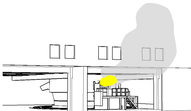
Figur 9.6 Røykutslipp gjennom åpning i vegg.
