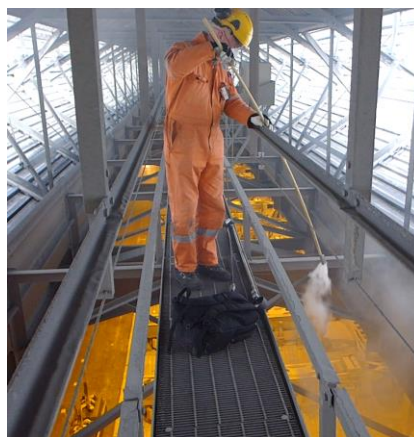
Figur 11.9 Kontrollér at luften i måletverrsnittet strømmer rette veien, og at utstrømningen er stabil. Vind kan forårsake omvendt strømningsretning. Foto: Håkon Skistad
