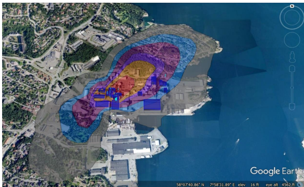
Figur 5.2 Støvkonsentrasjonsbidrag fra utslipp av støv, inkludert diffuse kilder. Fargeskalaen indikerer konsentrasjon av støv hvor rødt er høyeste verdi. De blå firkantene er bygninger (Gjengitt med tillatelse fra Norsk Energi)
