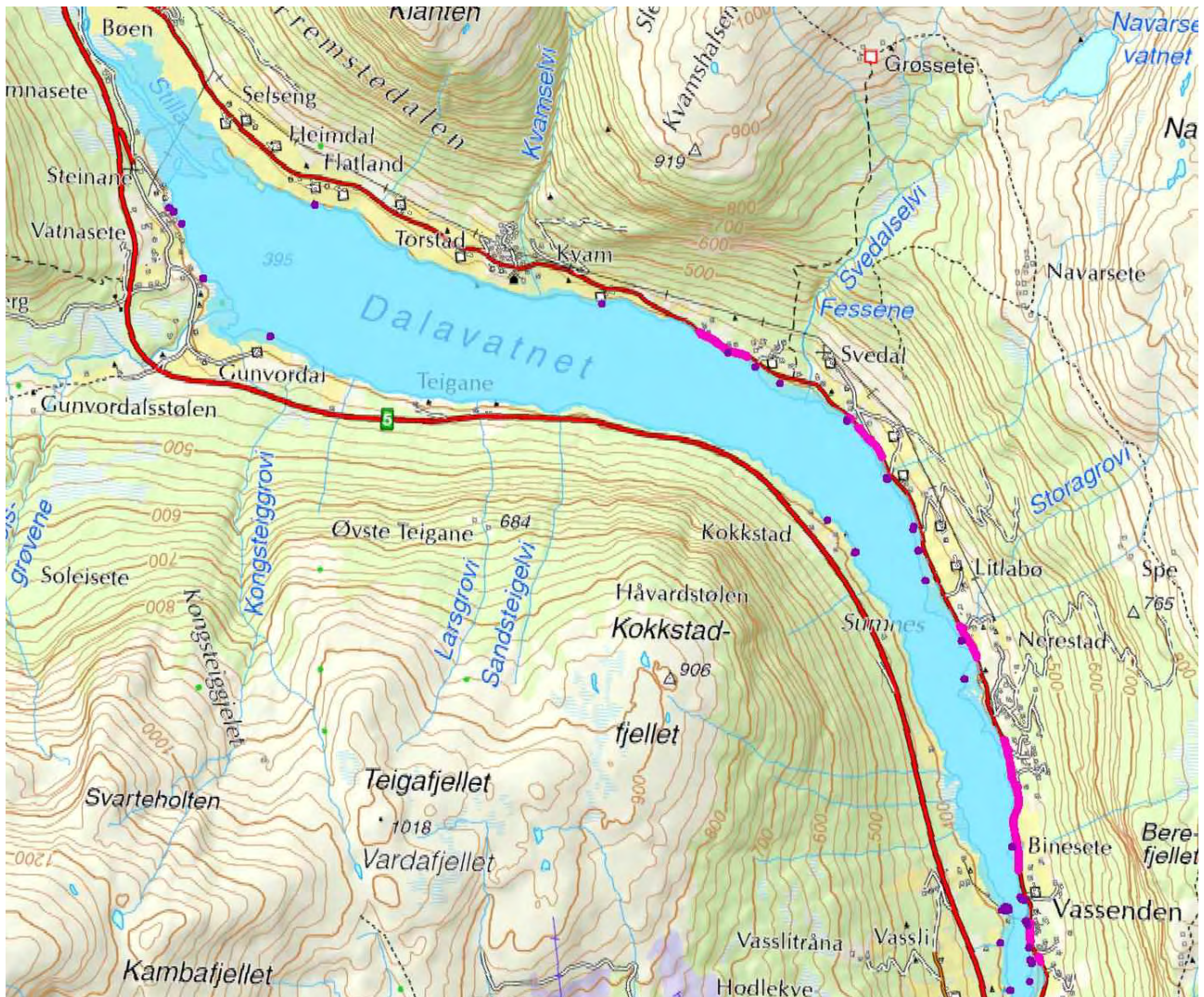
Figur 41 Råka bygg (markert med lilla farge) og infrastruktur (veg markert med rosa farge) ved Dalavatnet ved Q_{200} inkludert 20% klimafaktor med Dalavatnet brukt som flaumdempingsmagasin (vasstand på 397,5 med grunnlag i Tabell 11).
