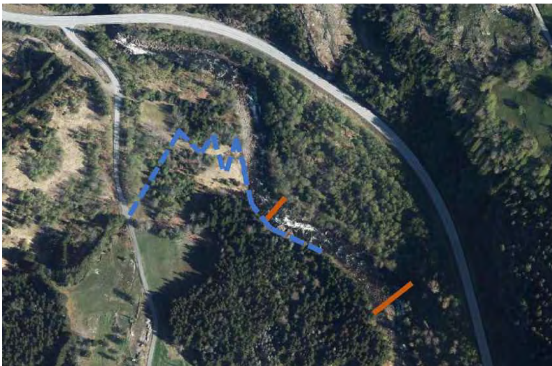
Figur 47 Mogleg masseuttak med terskel ved Ospesete (1). Bunnlastsperre er vist med brun strek, tilkomstveg er vist med stipla blå strek.
