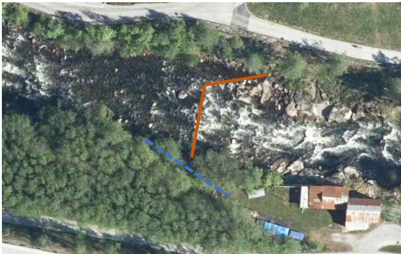
Figur 80 Potensiell stad for eit massbasseng i svingen oppstrøms Fossbrui. Botnlastsperre er vist med brun strek, tilkomstveg er vist med stipla blå strek.
