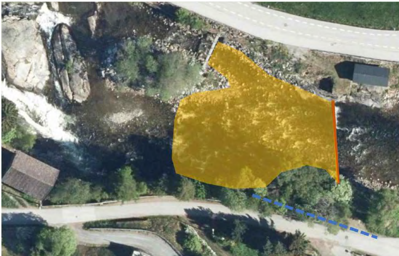
Figur 81 Potensiell stad for eit massebasseng ved Fossgarasjen. Botnlastsperre er vist med brun strek, tilkomstveg er vist med stipla blå strek.
