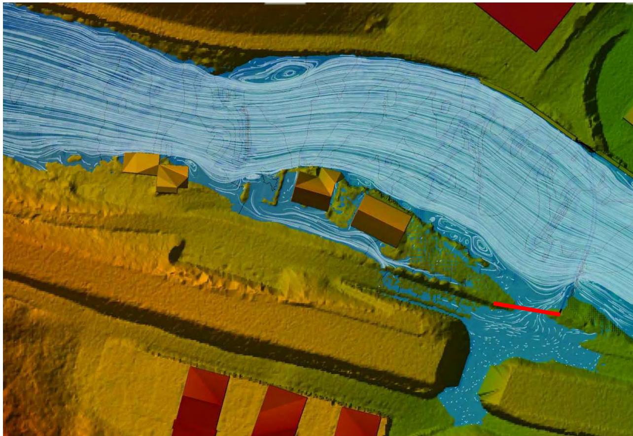
Figur 58 Flaumsikring ved lågpunkt oppstraums Fossbrui er vist med raud strek
