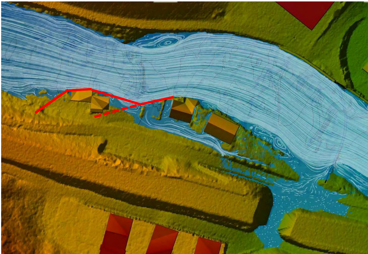
Figur 56 Flaumsikring ved bustadhusa i Møllevegen 36-38 er vist med raud strek (alternativ med sikring av berre bustadhusa er vist med stipla linje)
