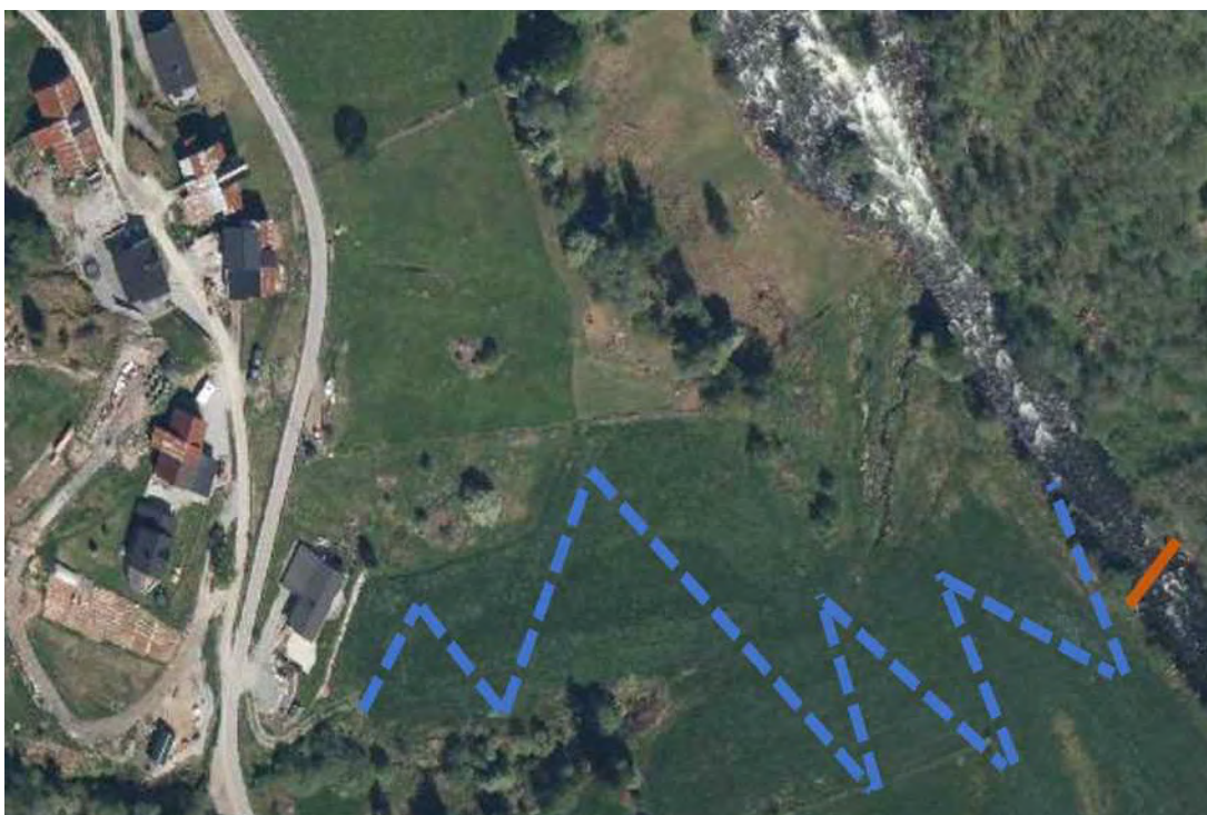
Figur 48 Mogleg masseuttak med terskel ved Lerheim (2). Bunnlastsperre er vist med brun strek, tilkomstveg er vist med stipla blå strek.
