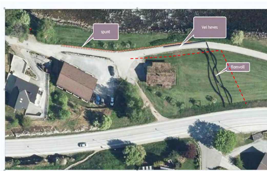
Figur 70 Flaumsikring ved hytta til SJSL (alternativ løysing med flaumbarriere ved tilkomst til hytta vist med raud stipla linje)
