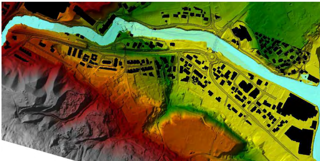
Figur 20 Overfløymd område ved 20-årsflaum
