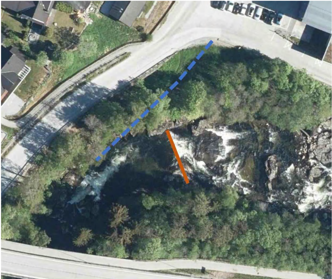
Figur 79 Potensiell stad for eit massbasseng i svingen nedstraums Ingafossbrui. Botnlastsperre er vist med brun strek, tilkomstveg er vist med stipla blå strek.
