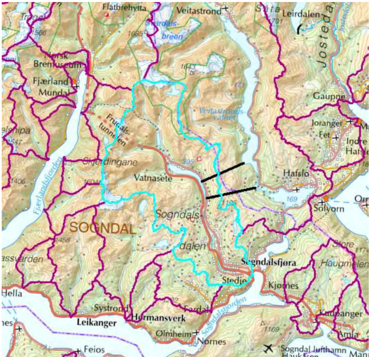
Figur 42 Sogndalselvi og nabofelta. Skissert lokalisering av potensielle overføringer til Arøyvassdraget vist som svarte linjer
