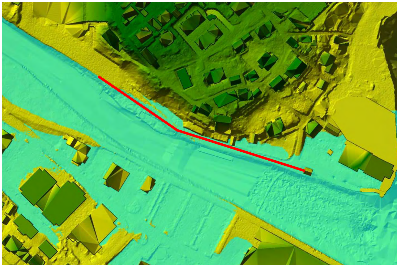
Figur 78 Flaumsikring mellom Doktorøyni og naust ved Lerumbrygge er vist med raud strek
