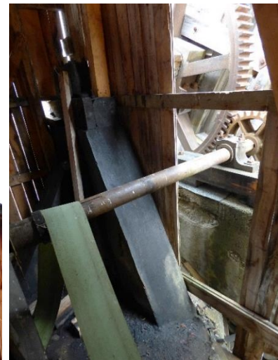
Vannhjulets kugghjul driver saga.
