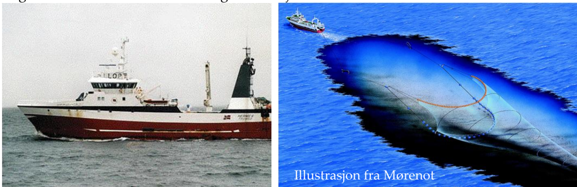
Figur 13. Bilde av en hekktråler og illustrasjon av en enkel bunntrål.
