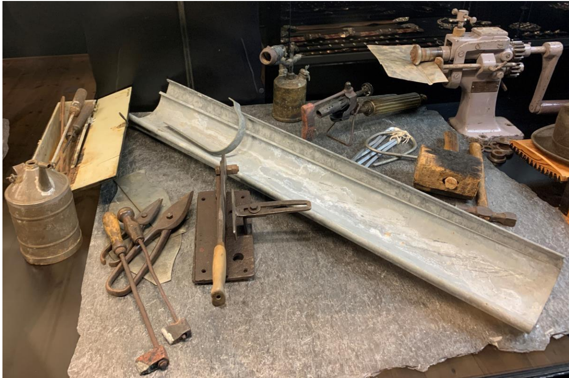
Figur 74. Redskaper og produkter til blikkenslagerarbeid. På bildet kan du se en takrenne med en lengde på 1 meter. Dette var formatet som taterne arbeidet i. Jf. funn 11/figur. 22.
