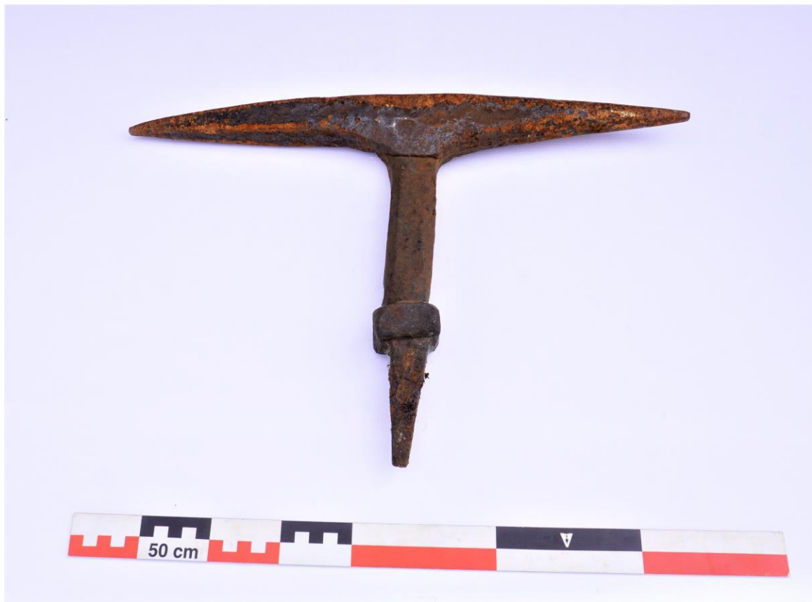
Figur 71. Reiseambolt. Denne kunne man feste i en «huggestabbe». En del bønder hadde en slik stabbe med hull som passet til ambolten, som taterne kunne få låne til reparasjoner eller håndverk.
