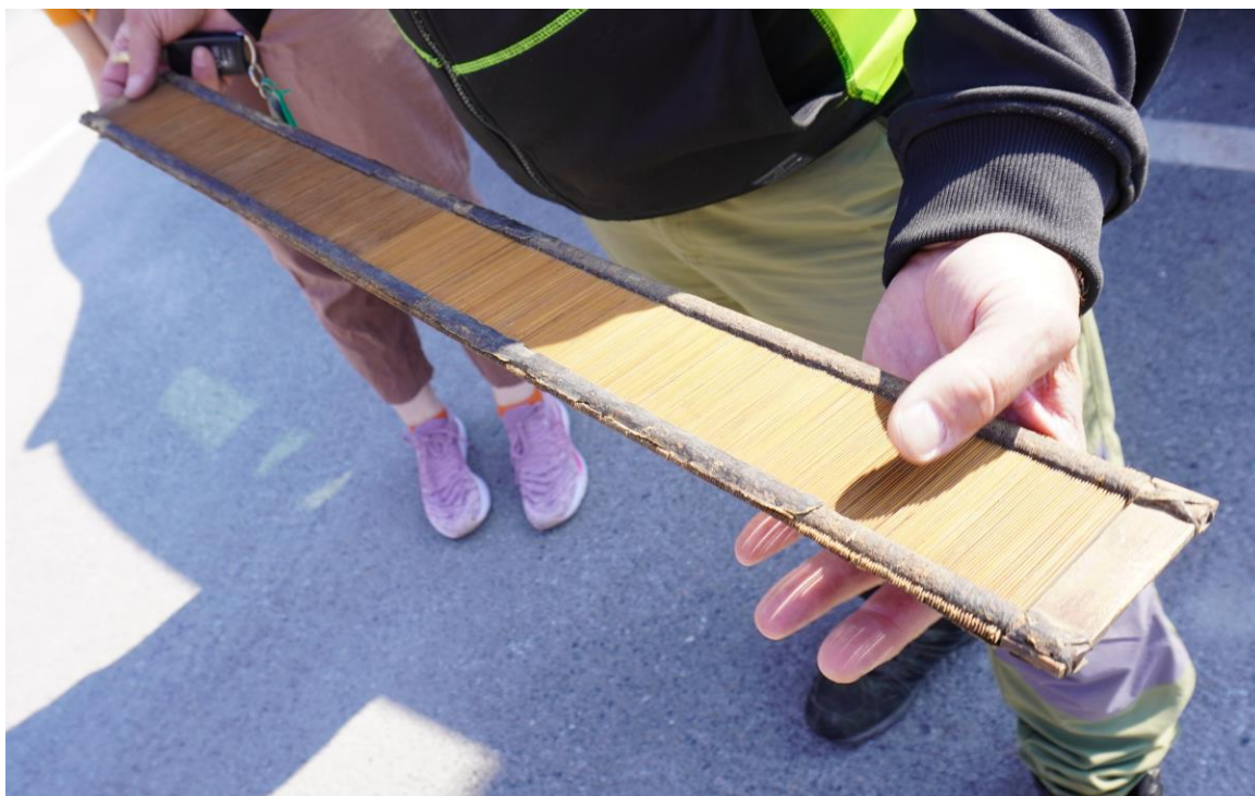
Figur 73. Vevskje er et redskap som består av en rektangulær ramme med et stort antall tynne spiler på tvers. Vevskjeen holder trådene fra hverandre når man vever.
