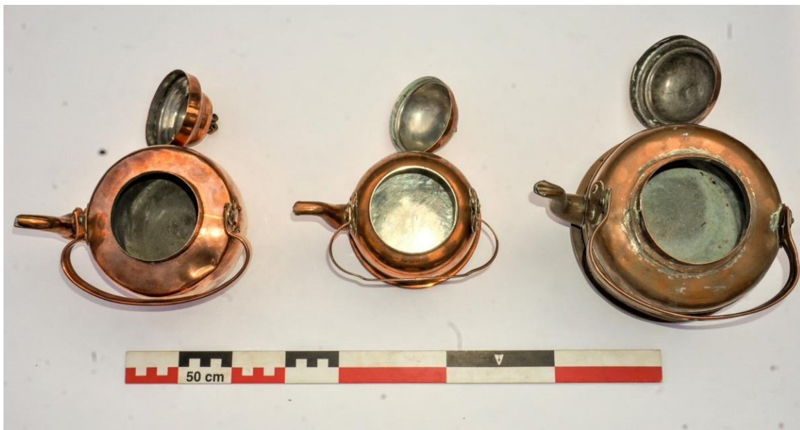
Figur 66. Kaffekjeler som er fortinnet på innsiden (merk at kjelen i midten er industrielt fortinnet). Fortinning av kobberkar og -kjeler er en teknikk som brukes for å hindre forgiftning ved bruk.
