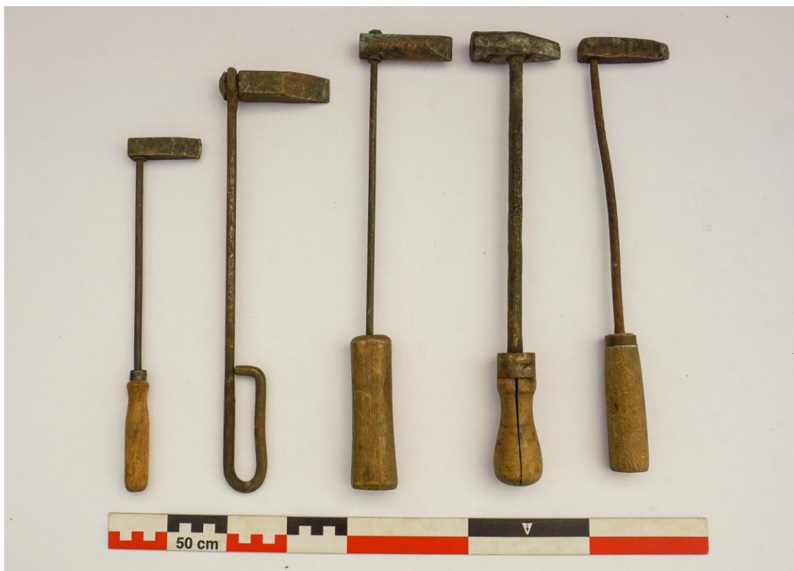
Figur 68. Loddebolter til metallarbeid. Loddeboltene på bildet er ikke elektriske.
