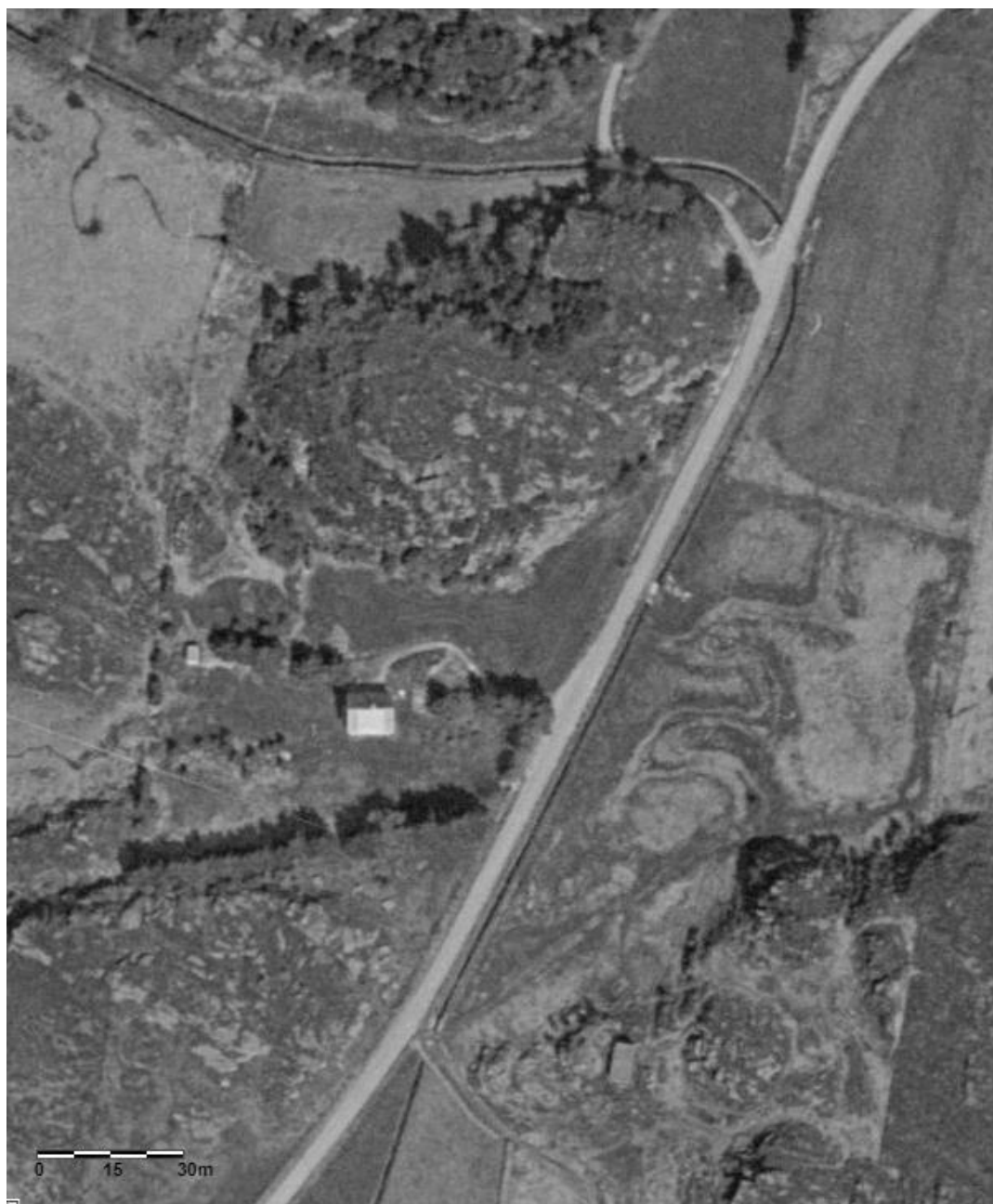
Figur 57. Flyfoto av Hapaløkbekken i området ved Vestre Veaveg, fra segment 8 til 13 fra 1964. På høyre side av Vestre Veaveg går bekken parallelt med veien, mens en tydelig kan se hvor bekken tidligere har slynget seg til høyre for den utrettete strekningen. Oppe til venstre ser en også en avsnøring av det opprinnelige elveløpet. På den utrettete strekningen i segment 13 har elven blitt redusert fra 230 meter til 135 meter (41 %).
