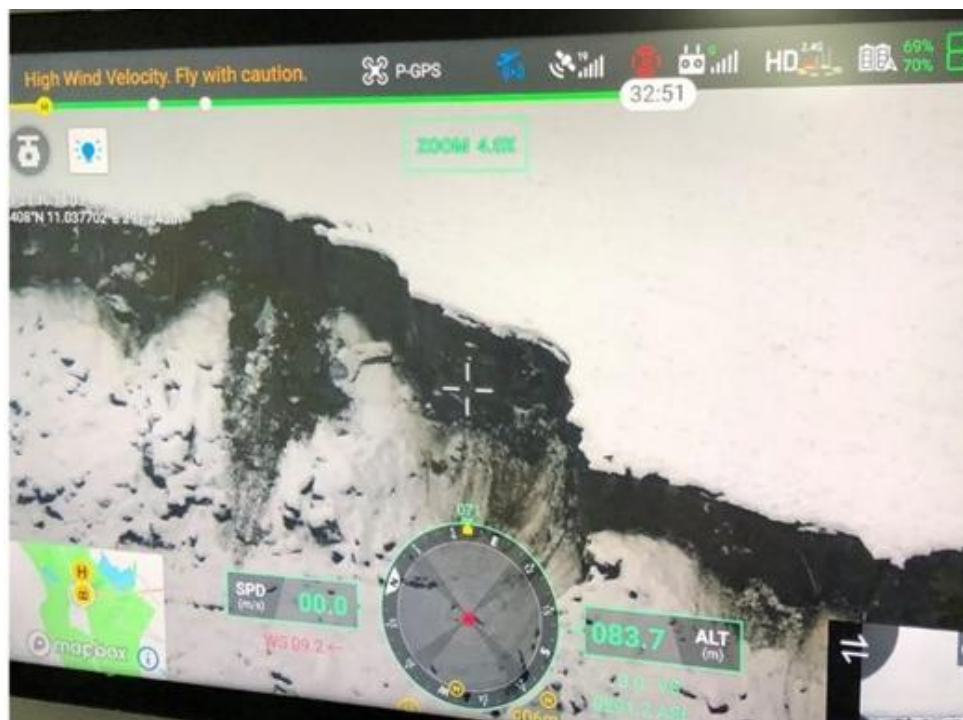
Figur 25. Eksempel på erosjon og utvasking observert langs østlige deler av skredkanten i forbindelse med snøsmelting og kraftig regn den 21.01.2021. (Bilde: Drone Andøya Space AS).
