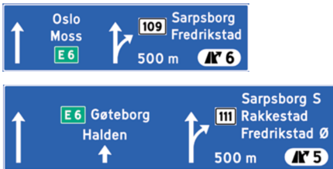
Figur 8.3.11—4 — Eksempler på portalorienteringstavle 709.3
