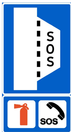
Figur 6.4.36—2 — Skilt 555 med serviceskilt 600.21H
