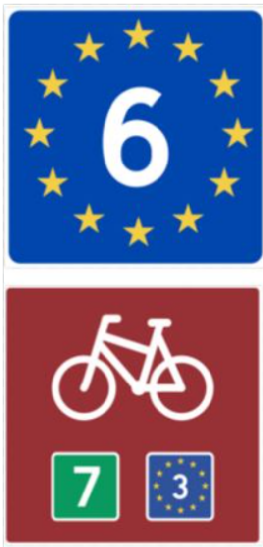
Figur 8.7.3—2 — Utforming av og eksempel på bruk av EuroVelo rutenummer sammen med rutenummer for nasjonal sykkelrute
