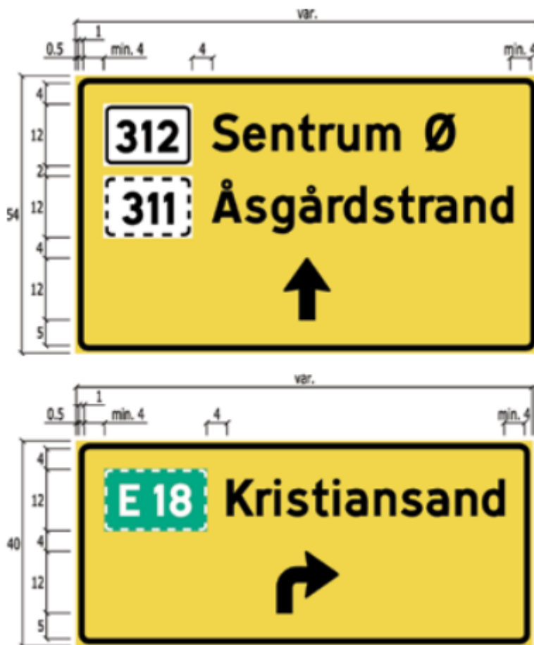
Figur 8.3.9—4 — Eksempler på utforming av skilt 709.12
