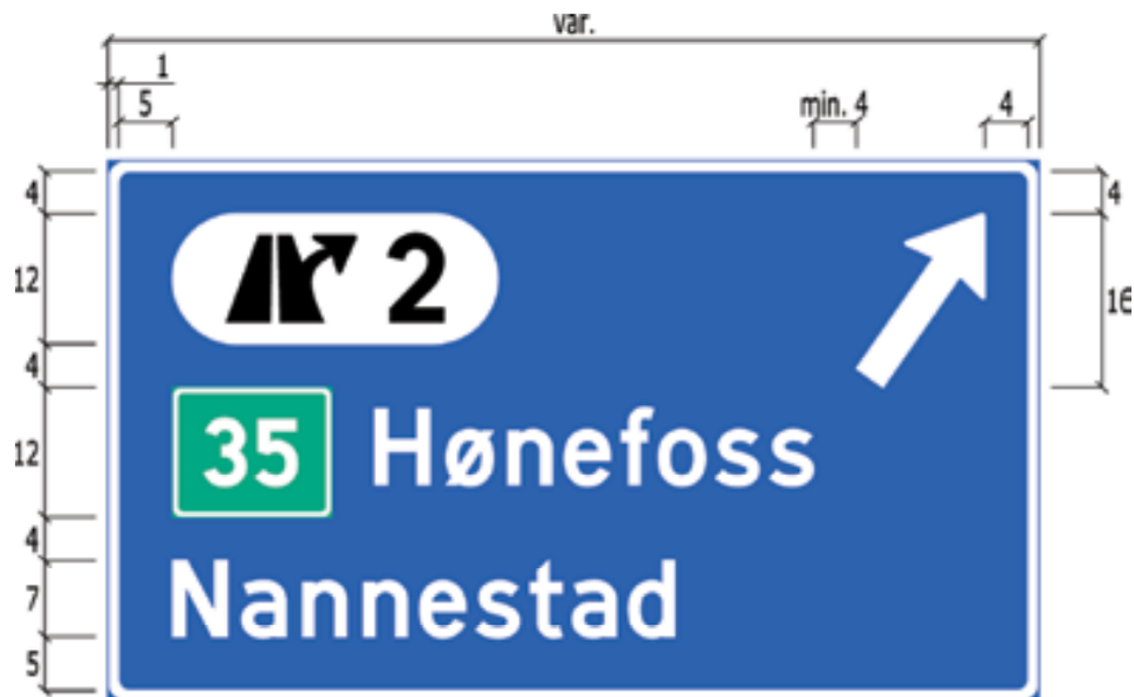
Figur 8.4.7—4 — Eksempel på utforming av skilt 719.4
