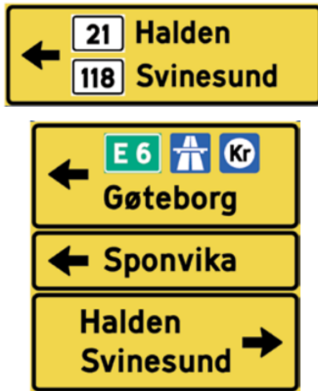
Figur 8.4.1—3 — Eksempel på skilt 711 med en skiltenhet for en retning og flere skiltenheter for ulike retninger
