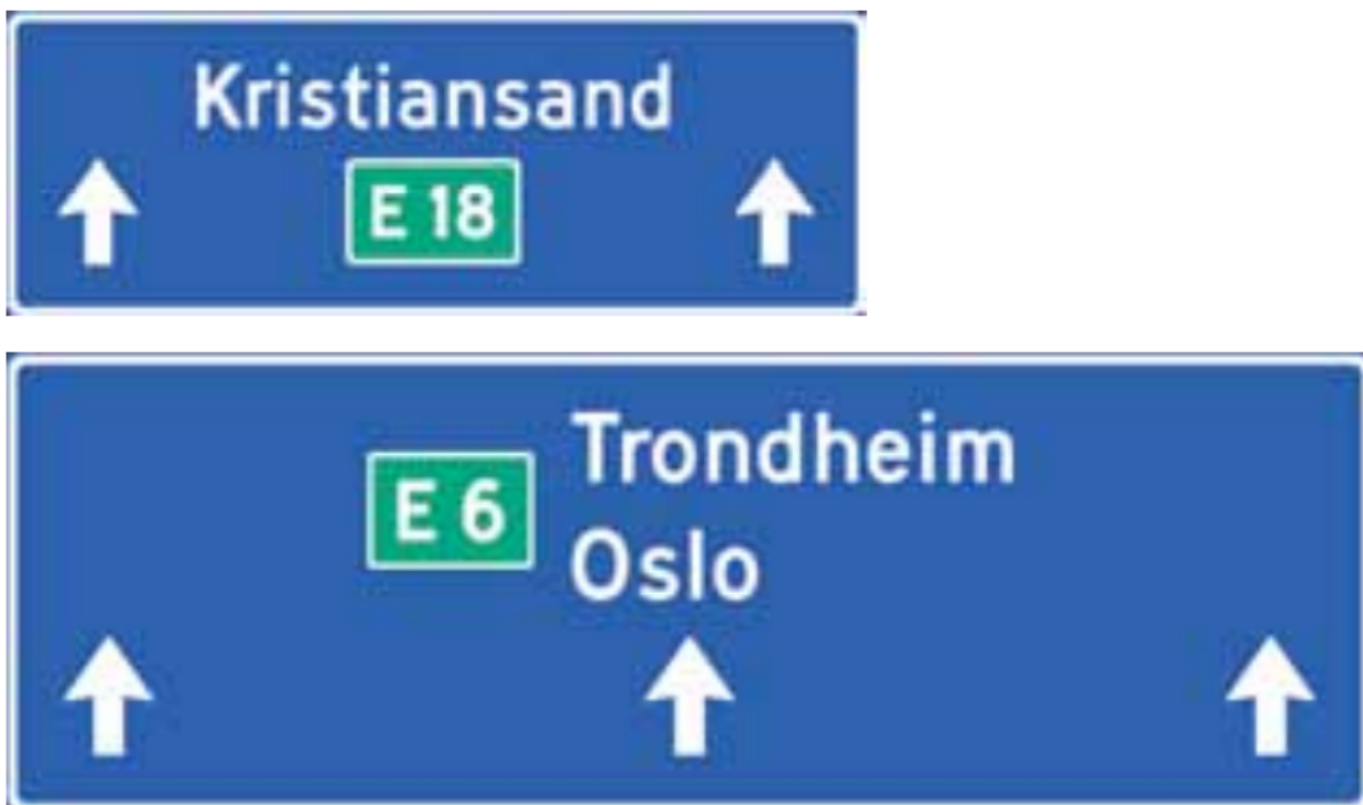
Figur 8.4.6—2 — Eksempler på portalorienteringstavle 719.2
