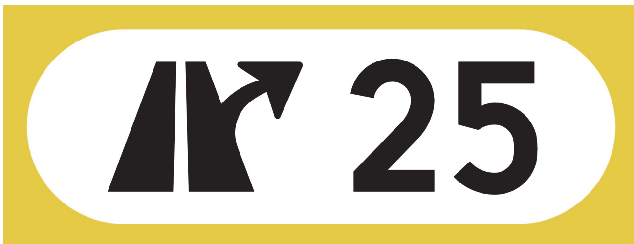
Figur 8.5.1.7—2 — 723.72 Kryssnummer for annen flerfeltsveg med planskilte kryss
