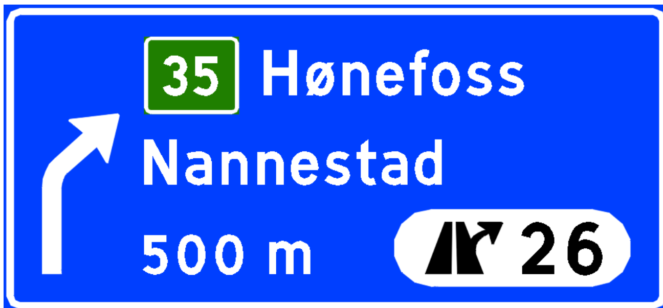
Figur 8.3.12—1 — 709.4 Portalorienteringstavle for feltsubtraksjon
