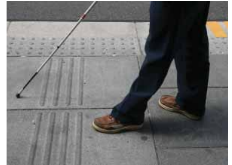
Oppmerksomhetsfelt på tvers av et fortau og farefelt langs et trikkestopp
