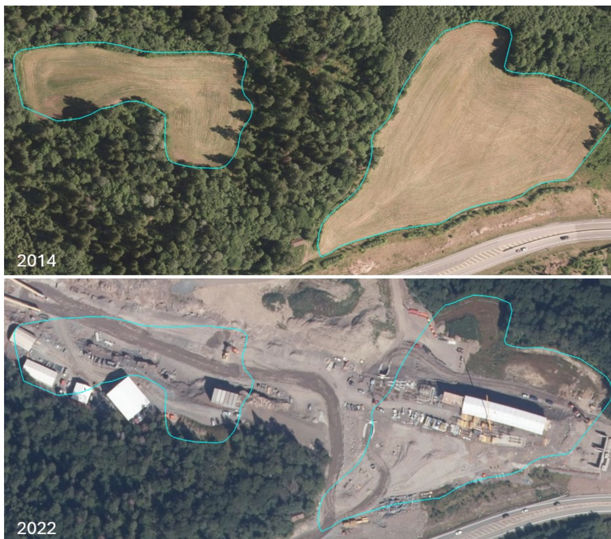
Figur 7.15 Eksempel fra E16 ved Bjørumsaga viser tidligere dyrka jord som er endret til åpen fastmark i byggeperioden, på bakgrunn av flybildene fra 2022 (nederste bilde). Disse arealene må regnes med som nedbygd jordbruksareal.
