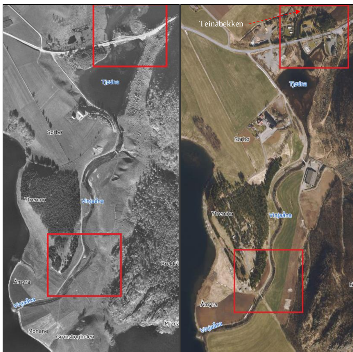
Figur 120. Eksempler på morfologiske inngrep i Vinjaåna. Flyfoto hentet fra norgebilder.no . Til venstre fra 1965 og til høyre fra 2022. Rødt omriss indikerer de mest påvirkede områdene.
