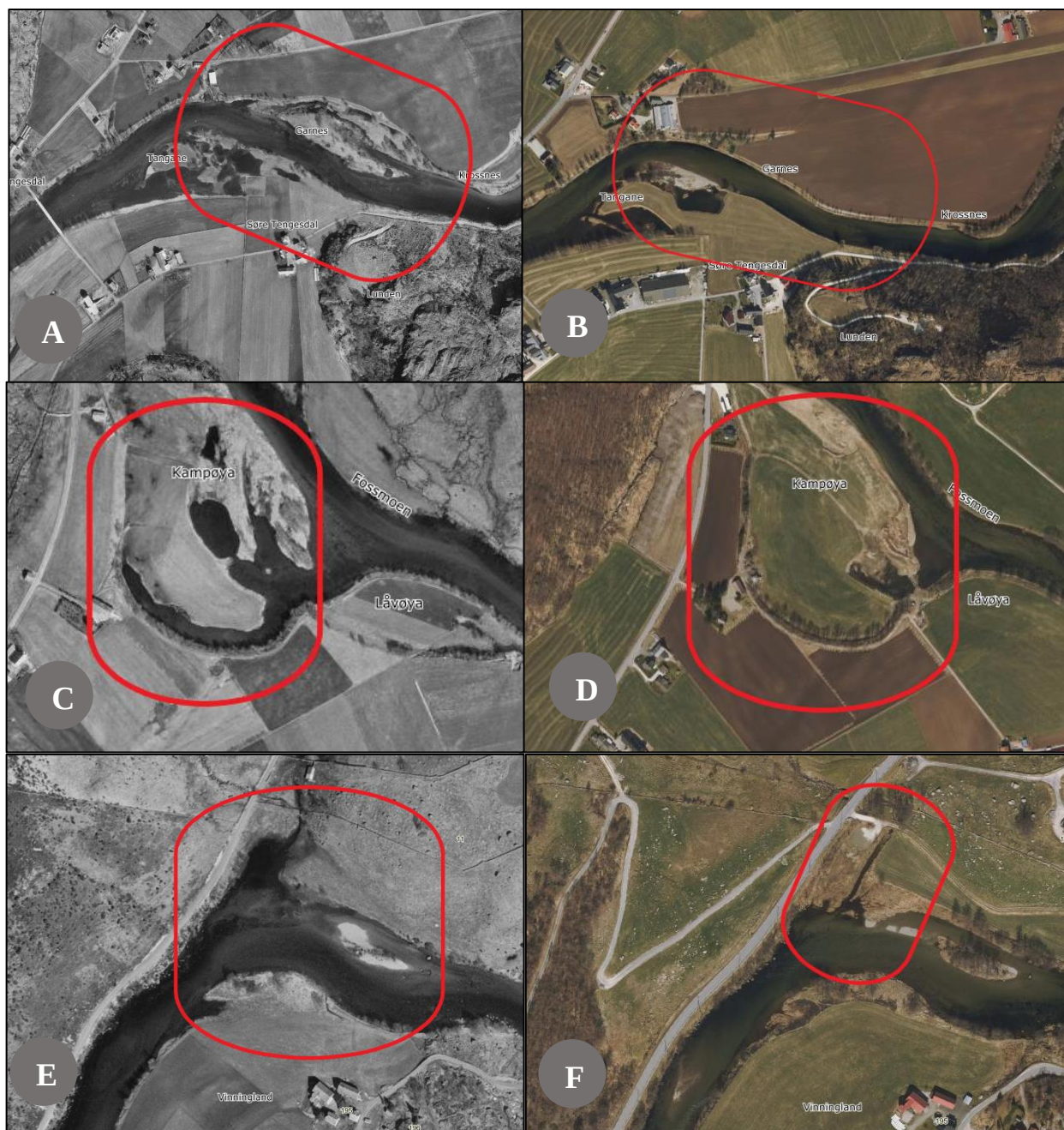
Figur 20. Eksempler på morfologiske inngrep i Bjerkreimselva. Flyfoto hentet fra norgebilder.no . Til venstre fra 1967 og til høyre fra 2022. A og B) utrettet strekk (indikert med rødt omriss) i segment B1, ved Garnes i Bjerkreimselva. C og D) Modifiseringer av løpet ved Kampøya i segment B1. E og F) Utfylling av kulp ved Vinningland i segment B5.
