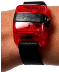
Figur 3.12 Bildet viser akselerometer sensoren ActiGraph som ble benyttet for å måle energiomsetningen under Studie II – den svært krevende feltøvelsen.
