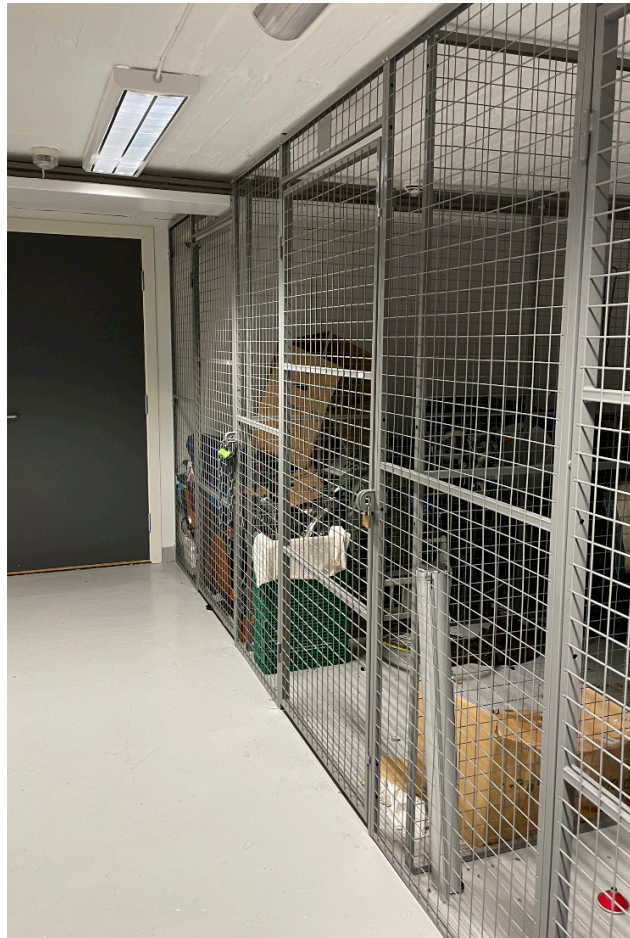
Eksempelbilde på et bodanlegg som ikke anbefales. Veggene bør være tette for å hindre innsyn inn i andres boder for å reduserer faren for innbrudd.
