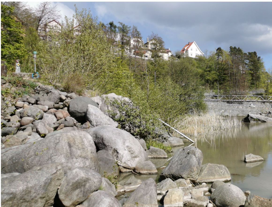
Figur 4. Plassering av automatisk måleutstyr for vannkvalitet ved øvre del av dam 3 i Farriselva. Logger er montert på stolpe og MPS i et 3 m langt stålrør.
