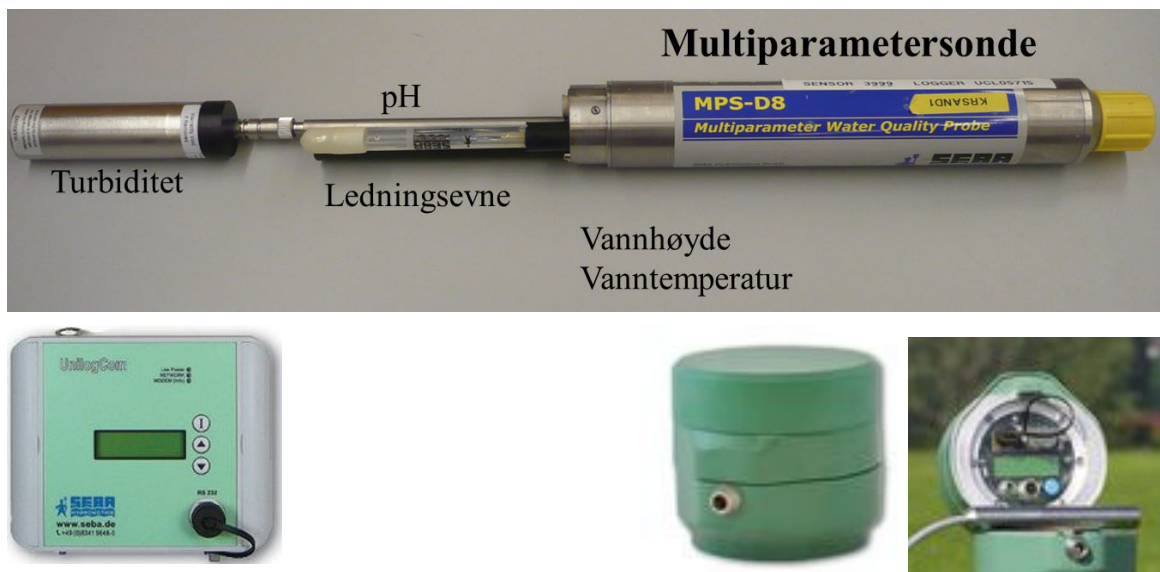
Figur 3. Øverst: Multiparametersonde (MPS-D8) for kontinuerlige automatiske målinger i miljøbøyer Farrisvannet og målestasjon Farriselva. Nederst t.v.: UnilogCom (datalogger og modem) benyttet i miljøbøyer. Nederst t.h. LogCom2 (datalogger og modem) benyttet ved målestasjon.
