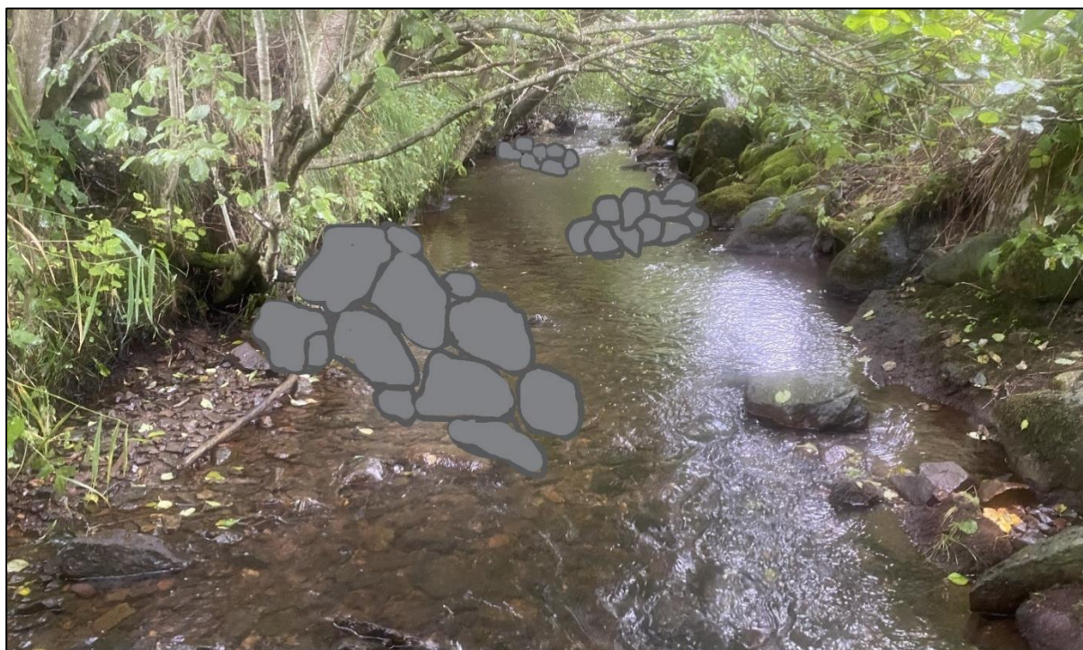
Figur 26. Illustrasjonsfoto med forslag til utforming av steinbuner (i grått) i segmentene 8-10, 12 og 15-16 av hovedløpet av Daleelva. Bunene etableres av naturstein (D=20-40 cm), og plasseres med ca. 10 meters mellomrom.
