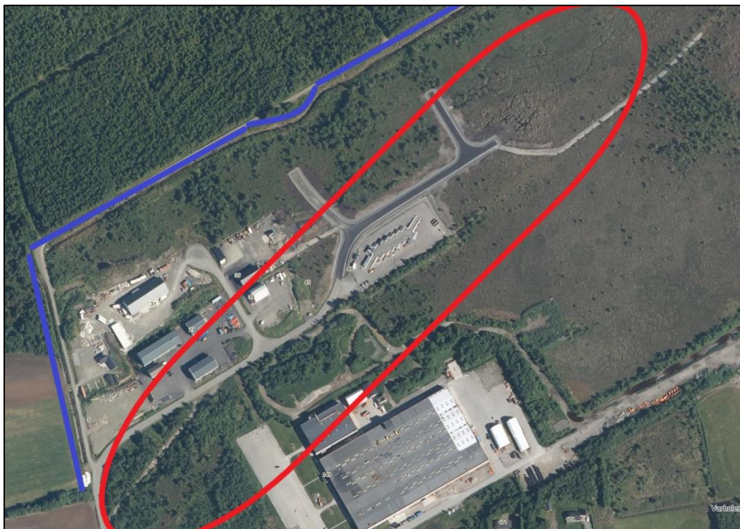
Figur 5. Endring av elveløpets utforming i øvre del av Daleelva, ved Varhol industriområde. Rødt omriss indikerer elveløpets utforming i 1960, og blå linje indikerer løpets utforming i dag. A) Bilde fra 1960: Naturlig meanderende elveløp gjennom myrområde. B) Bilde fra 2018: Flytting og kanalisering av elveløp i forbindelse med etablering av industriområde. Bilder hentet fra norgebilder.no .
