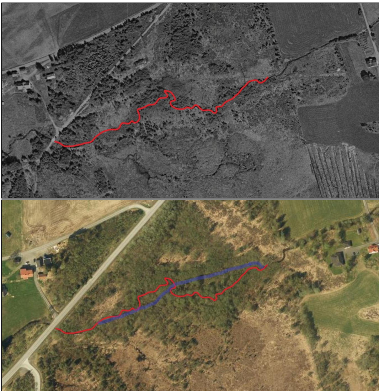
Figur 28. Flyfoto av Myrbostadgrova fra 1960 (oppe) og 2018 (nede) med innmerket opprinnelig meanderende elveløp (rødt) og dagens utrettede løp (blått). Det foreslås å tilbakeføre/gjenslyngne elven til sitt opprinnelig meanderende elveløp. Flyfoto er hentet fra norgebilder.no .
